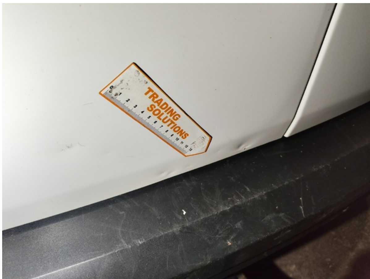
Dörr Vänster bak Bucklor under 3 cm Vänster transport dörr 800 kr
