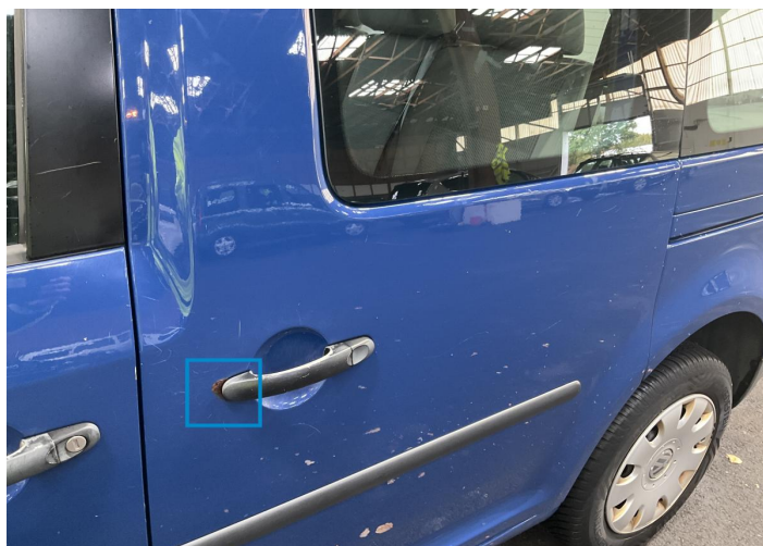
13. Door / Back Left Paint / Corrosion -
