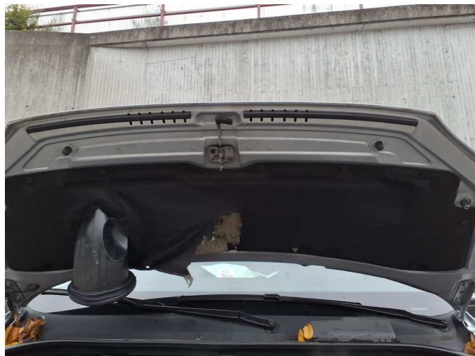
Damage 1: Bonnet: Insulation lining (Mehrkosten möglich) - Damage caused by marten / rodent - Replace
