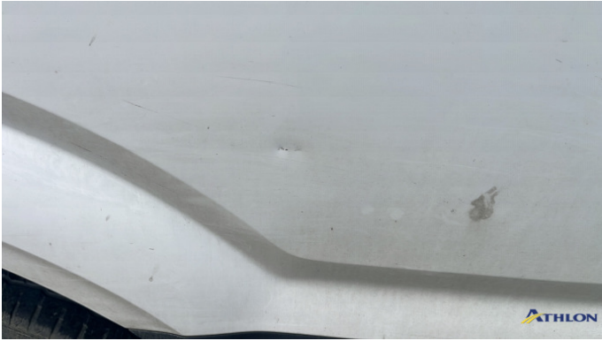
4. parete laterale - posteriore - sinistra Ammaccature/rigonfiamenti
