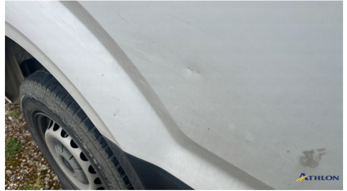
4. parete laterale - posteriore - sinistra Ammaccature/rigonfiamenti
