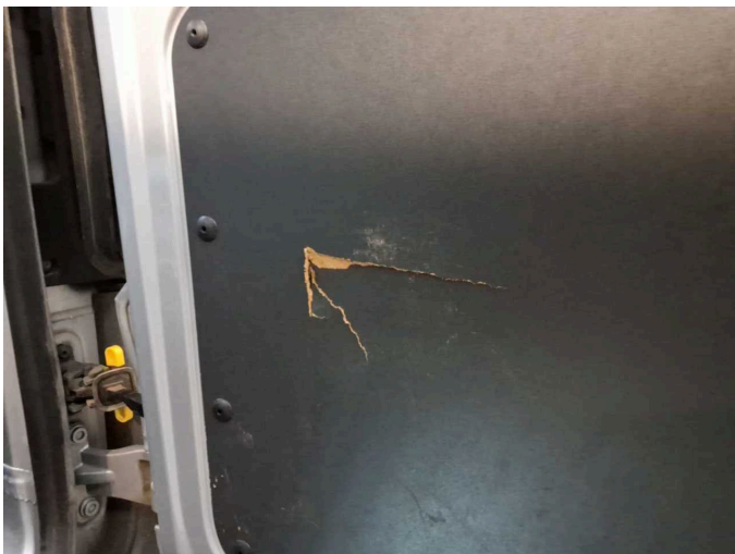
Damage 2: Boot lid / rear door: Rear door - right side (Verkleidung) - Broken / torn - Replace
