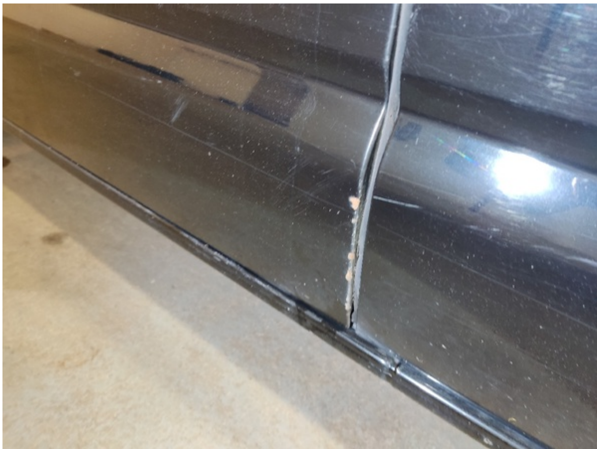
Dörr Höger skjutdörr Lackskador
