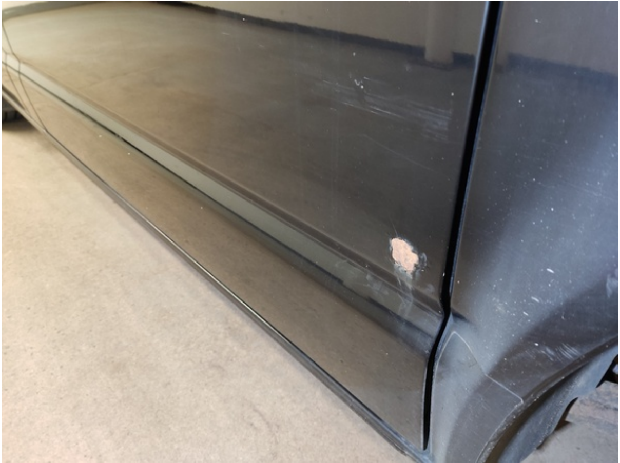
Dörr Vänster skjutdörr Lackskador
