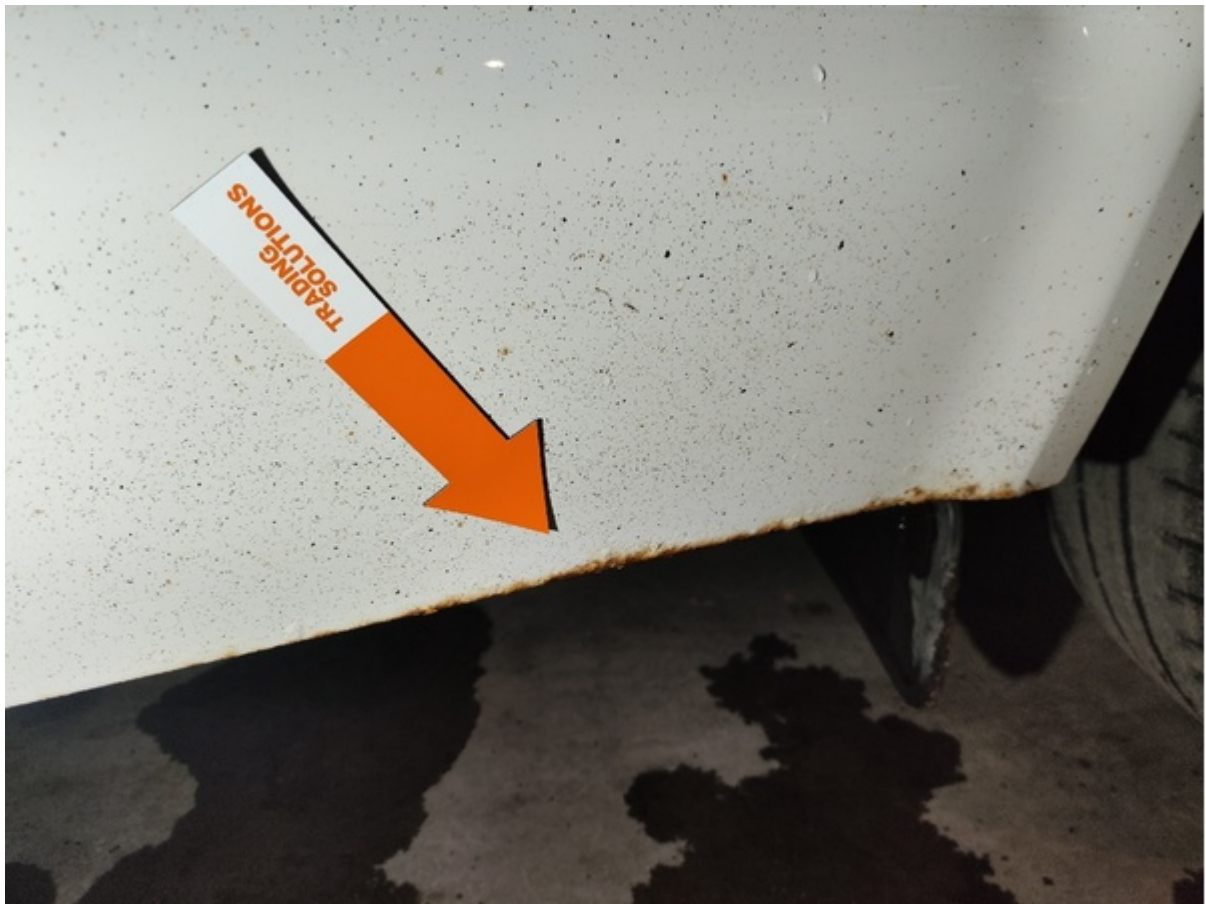
Dörr Höger fram Repor under 3 cm Rostfläckar 800 kr
