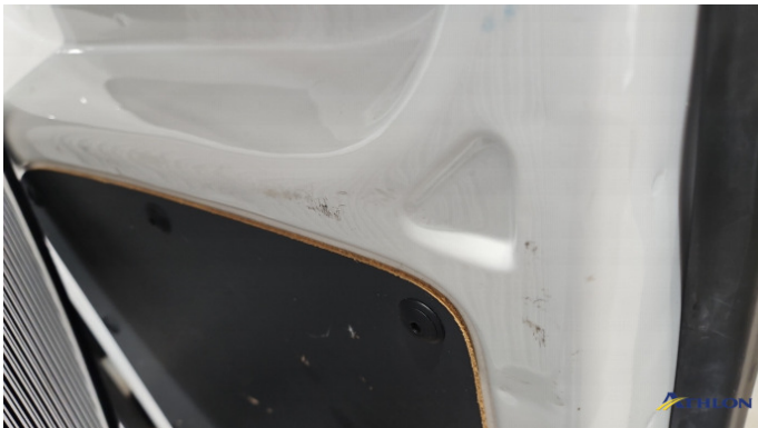
8. Hecktür Rechts Verformt (leicht)
