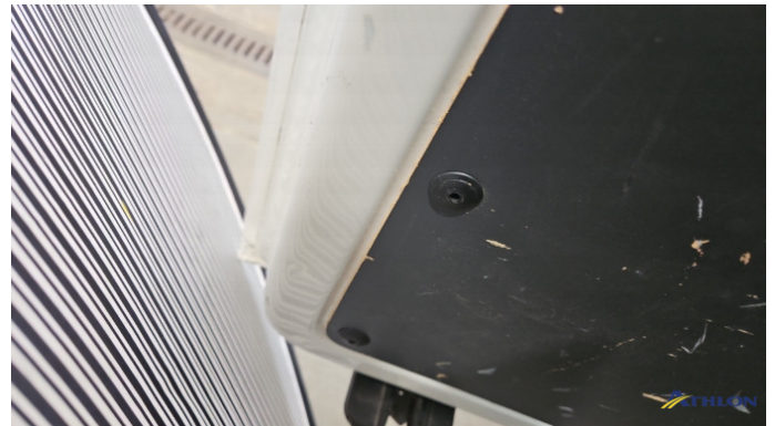
7. Hecktür Links Verformt (leicht)
