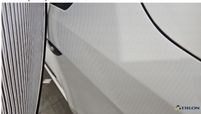
15. Kotflügel Vorne - Rechts Verformt (leicht)
