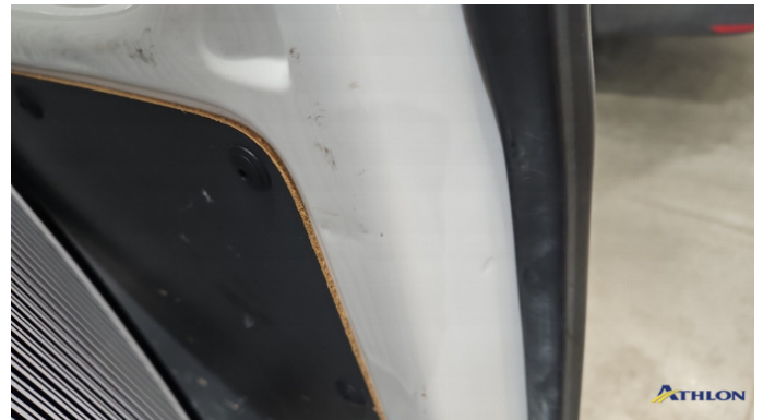
8. Hecktür Rechts Verformt (leicht)
