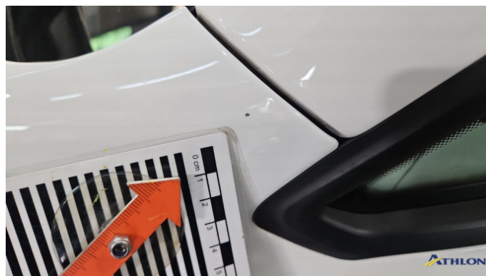
4. Kotflügel Vorne - Links Steinschlag
