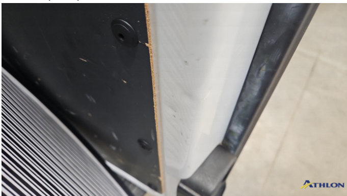
8. Hecktür Rechts Verformt (leicht)
