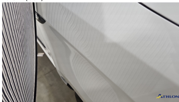
15. Kotflügel Vorne - Rechts Verformt (leicht)
