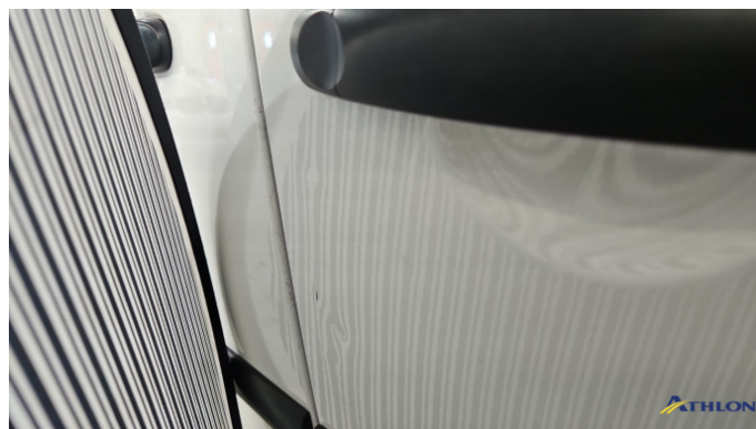
14. Tür Vorne - Rechts Verformt (leicht)
