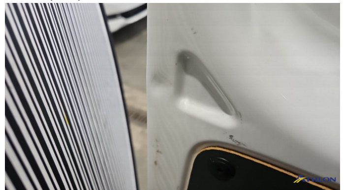
7. Hecktür Links Verformt (leicht)
