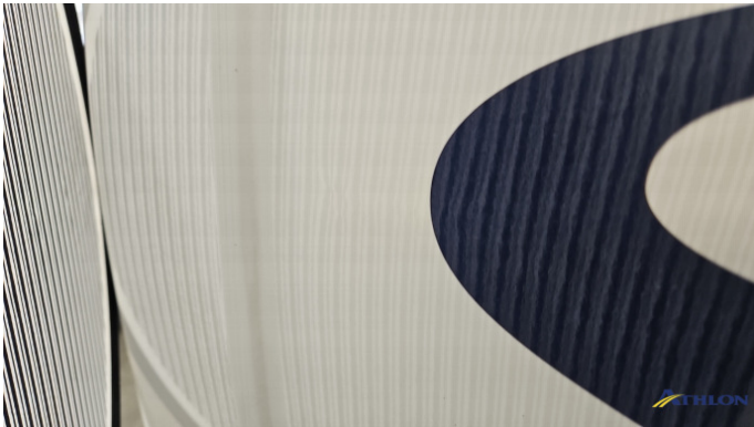
9. Seitenwand - Hinten - Rechts Verformt (leicht)
