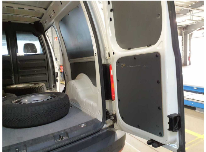
Damage 3: Boot lid / rear door: Rear door - right side (Verkleidung) - Broken / torn - Replace
