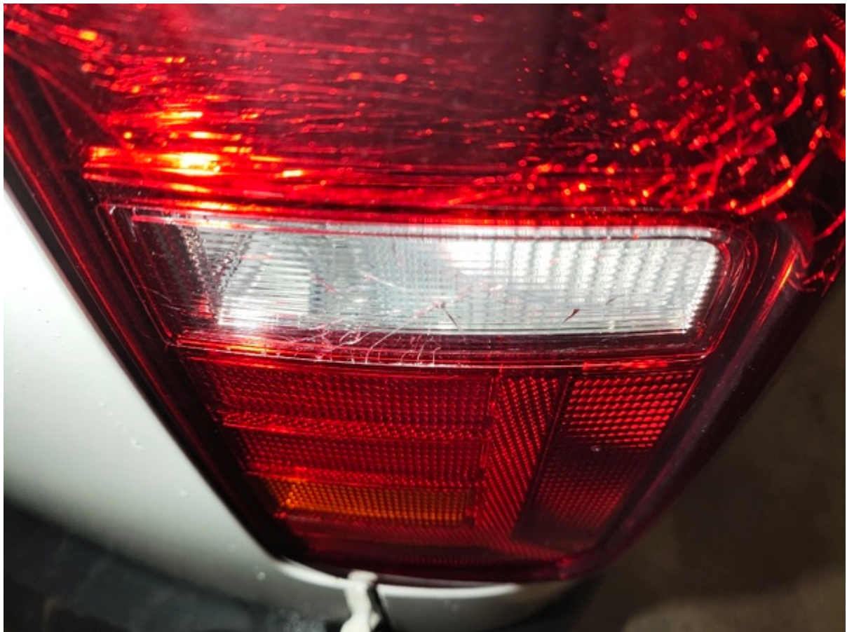
Lampor Bakljus Sprickor glas Höger
