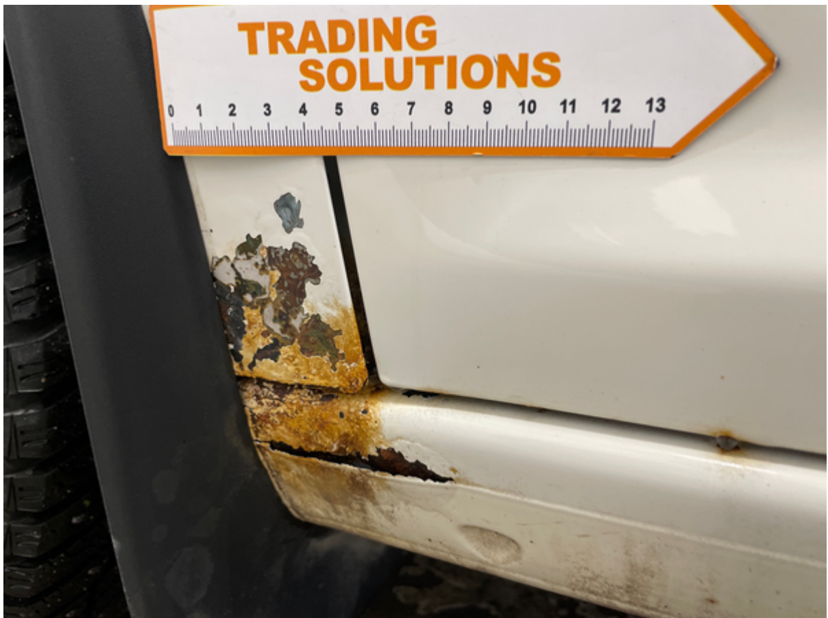
Trösklar Vänster Lackskador 5 000 kr
