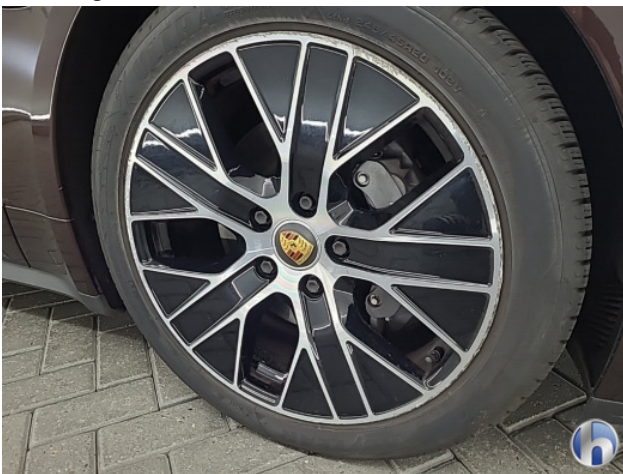
3. Velgen rondom Beschadigd - Herstellen
