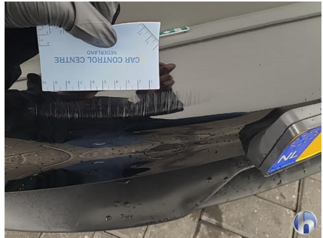
1. Voorbumper Krassen - Spot Repair/Deelreparatie
