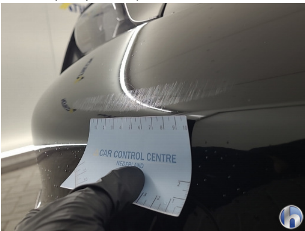
1. Voorbumper Krassen - Spot Repair/Deelreparatie
