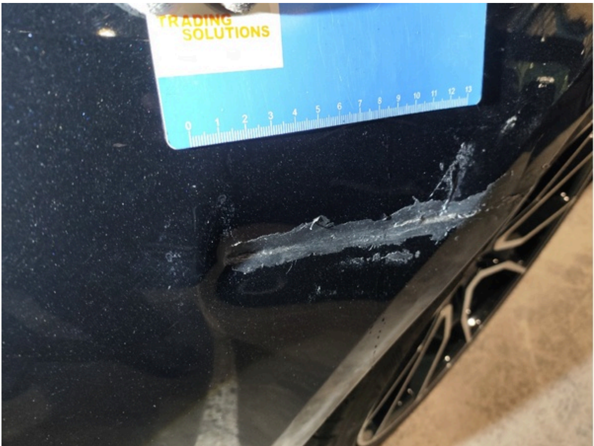
Stötfångare bak 1 Skada Lack/rikt Djupa revor samt inbukning 5 733 kr
