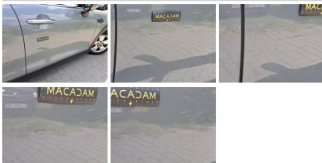
Sill trim R, Scratch(es), Replace
