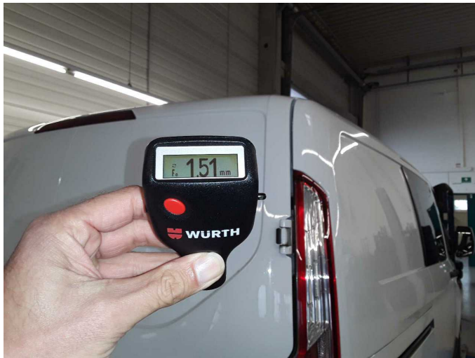
Boot lid / rear door: 1,510 \mu\text{m}
