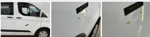
Scherf V R, Deuk(en), Herstellen en spuiten (compleet)
