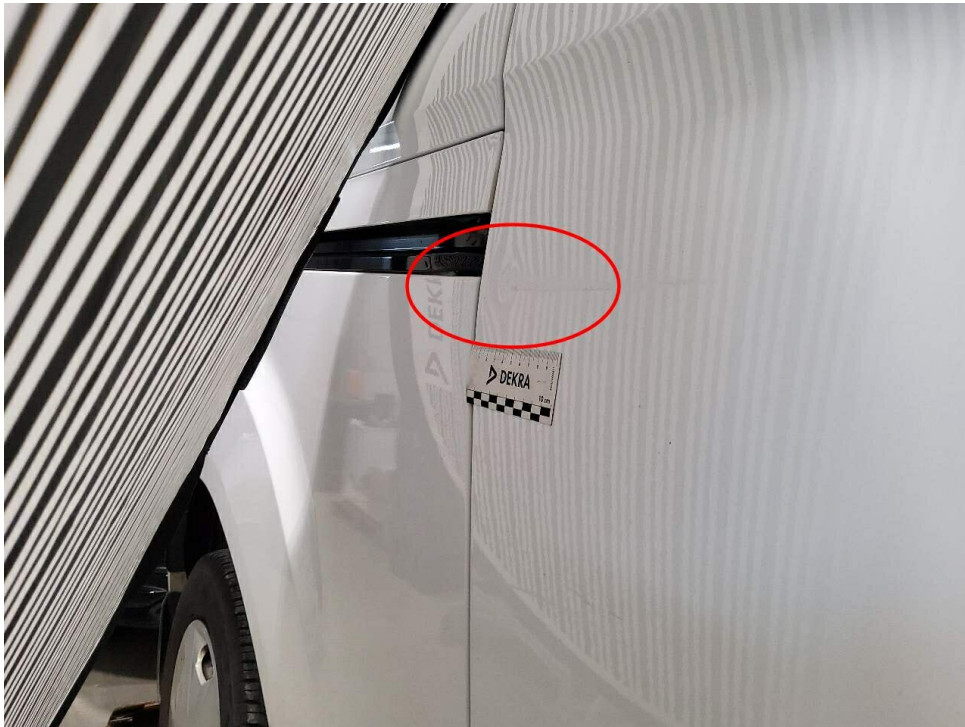
Bild 15 : Schiebetür rechts, eingedellt
