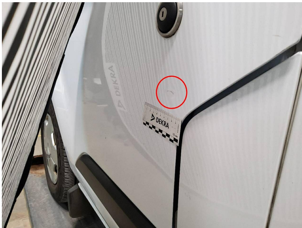
Bild 11 : Tür vorne links, eingedellt und verschrammt, Gebrauchsspur
