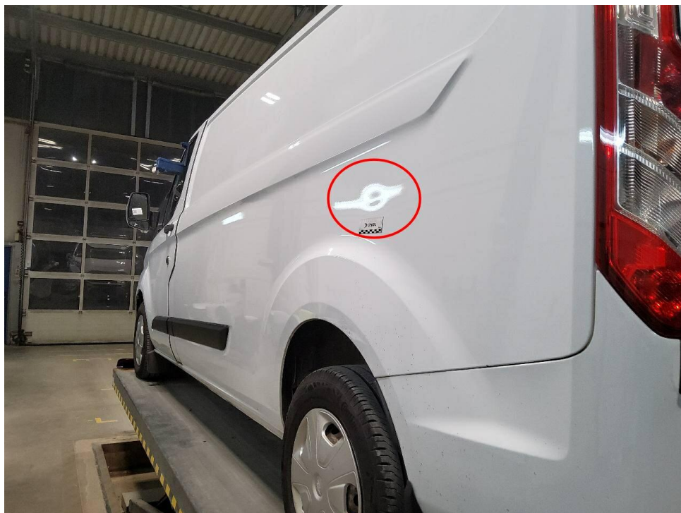
Bild 12 : Seitenwand links, eingedellt und verschrammt
