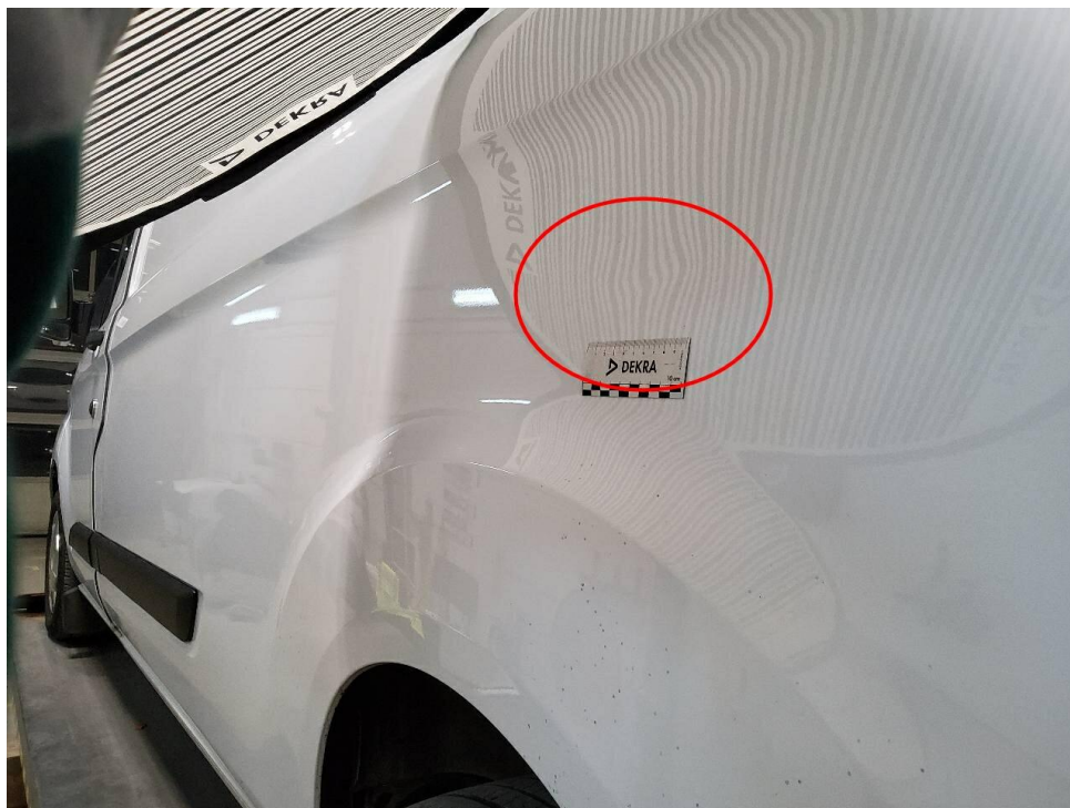
Bild 13 : Seitenwand links, eingedellt und verschrammt
