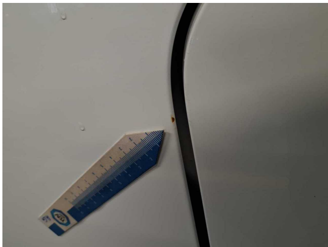
Damage 3: Door - front left side: Door edge (Kratzer) - Stone chips - Smart repair
