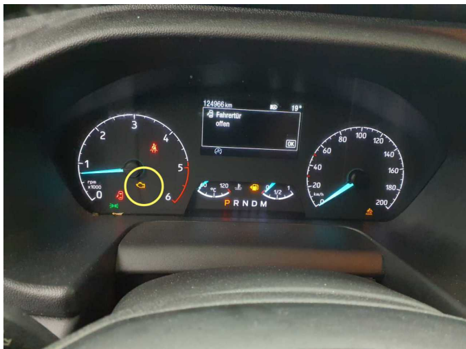
Damage 6: Instrument panel: Indicator light (Motorkontrollleuchte - Mehrkosten können entstehen) - on - Perform diagnosis
