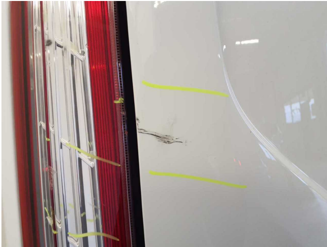
Damage 3: Boot lid / rear door: Boot lid (Delle) - Scratch(es) - Smart repair
