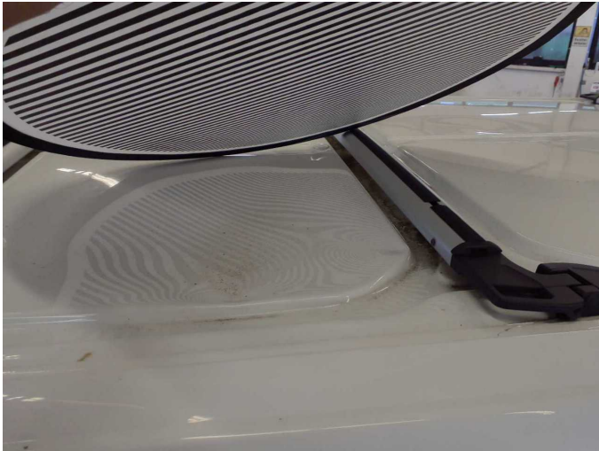
Damage 8: Roof: Roof (Rechte dach seite viele stellen eingedrückt +bäulen) - Deformed - Repair and paint
