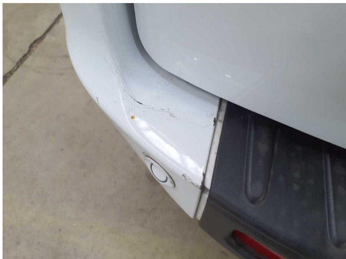
Damage 2: Rear bumper: Rear bumper (Mehrkosten können entstehen) - Scratched - Repair and paint
