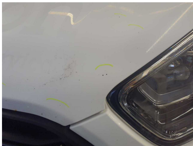
Damage 6: Bonnet: Bonnet (viele Steinschläge) - Scratch(es) - Paint
