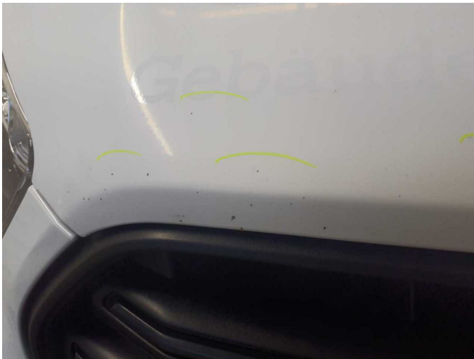
Damage 6: Bonnet: Bonnet (viele Steinschläge) - Scratch(es) - Paint
