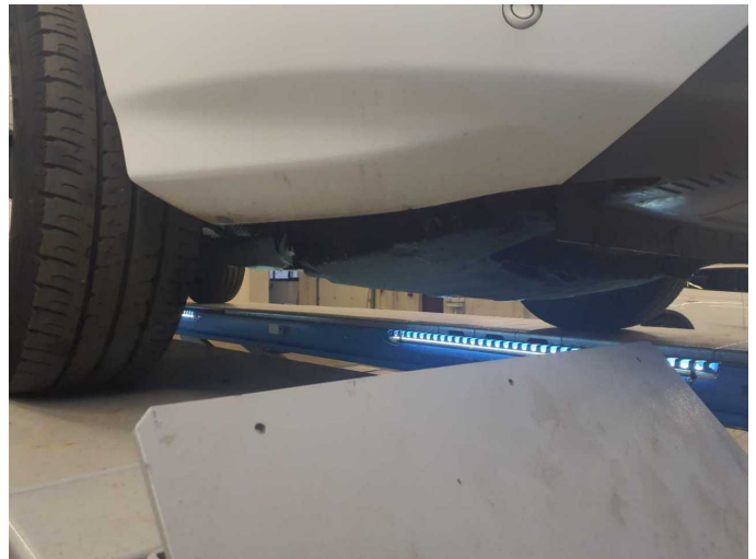
Damage 4: Body: Underbody panelling (Hängt runter/bauch nach unten) - Damaged - Replace
