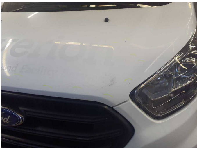
Damage 6: Bonnet: Bonnet (viele Steinschläge) - Scratch(es) - Paint
