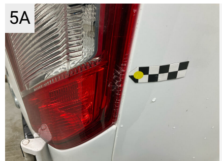
5A Sted Bagklap Del Lygte, Højre Type Revnet
