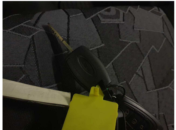
Damage 3: Equipment: Vehicle key mech. (Zündung einschalten möglich jedoch kein start-muss angelernt) - Non-operational - Diagnosed and repair if necessary
