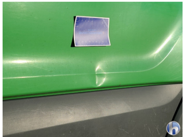
3. Portier voor - rechts Deuk/deuken - Herstellen
