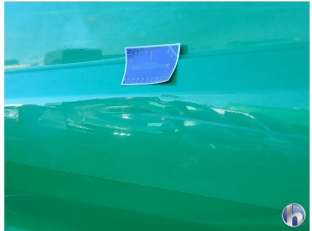
1. Zijwand - achter - Links Deuk/deuken - Herstellen
