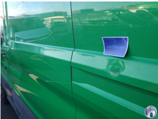
1. Zijwand - achter - Links Deuk/deuken - Herstellen
