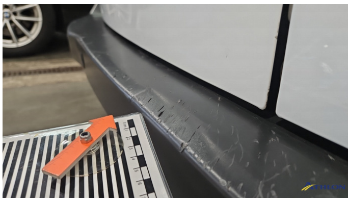
6. Stoßfänger Hinten Verformt (leicht)
