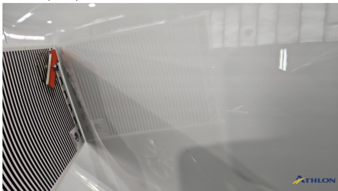
4. Seitenwand - Hinten - Links Verformt (leicht)
