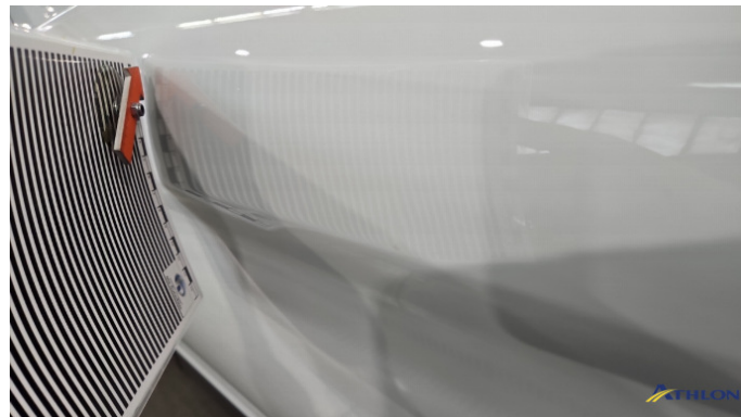
4. Seitenwand - Hinten - Links Verformt (leicht)
