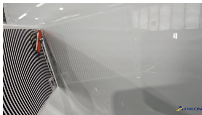
4. Seitenwand - Hinten - Links Verformt (leicht)
