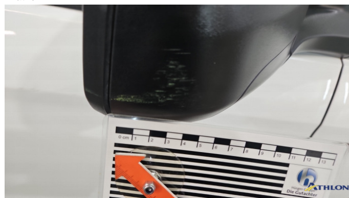
10. Außenspiegel Gehäuse - Rechts Kratzer
