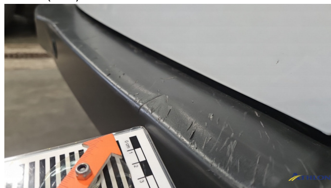
6. Stoßfänger Hinten Verformt (leicht)
