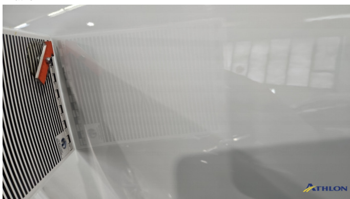
4. Seitenwand - Hinten - Links Verformt (leicht)
