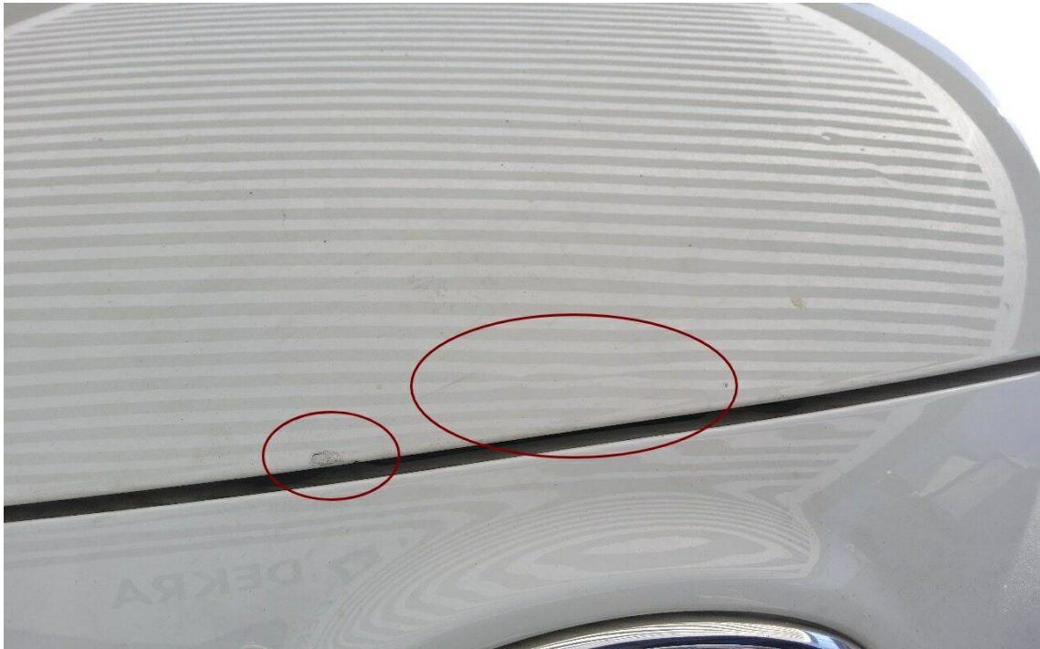
Bild 15 : Motorhaube Dellen, Knick und Lackschaden
