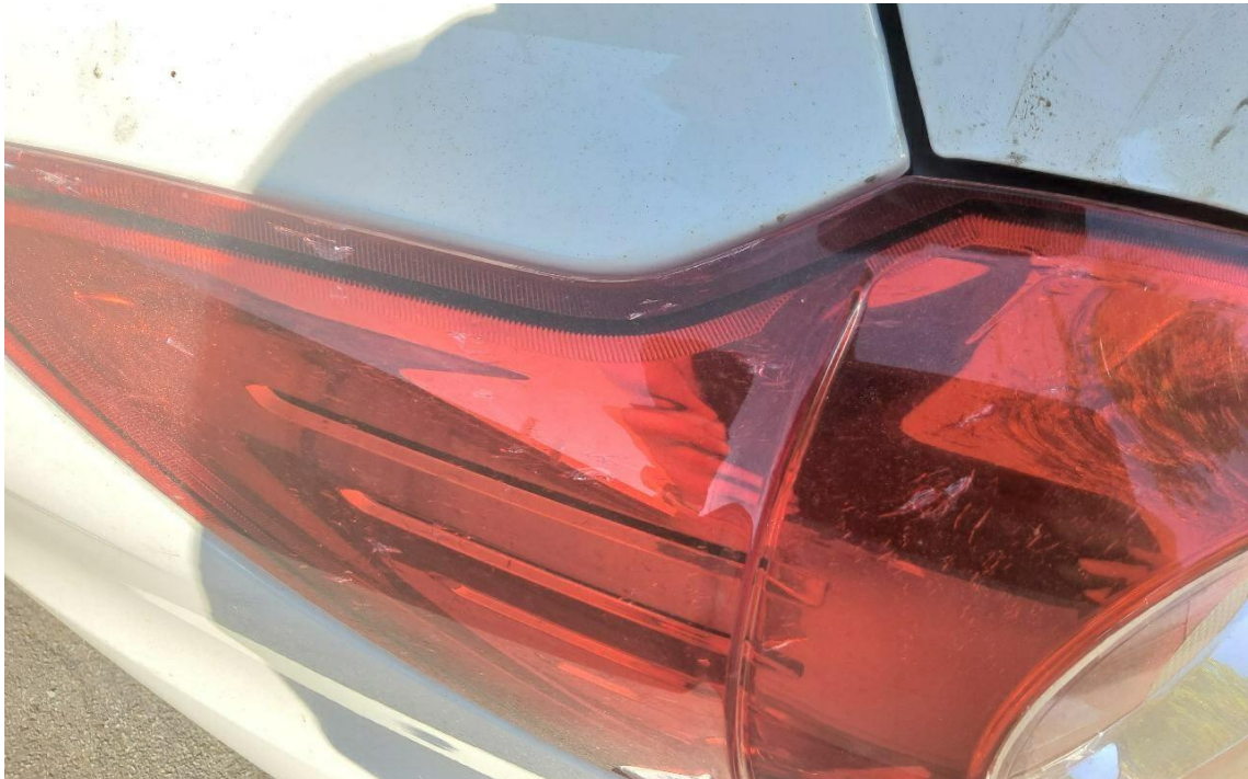
Bild 23 : Stoßfänger hinten gerissen und zerkratzt und Rückleuchte links gebrochen
