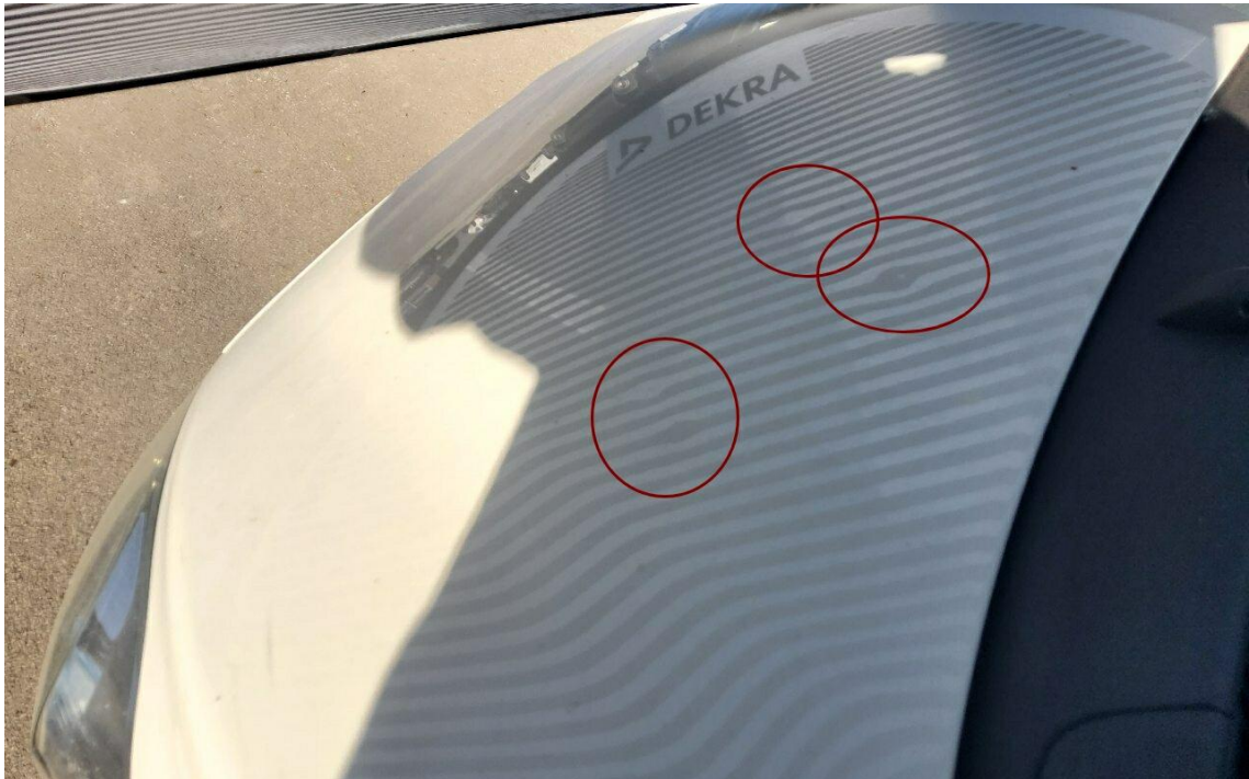
Bild 13 : Motorhaube Dellen, Knick und Lackschaden
