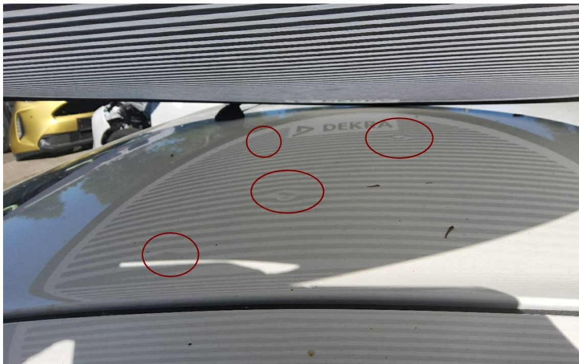
Bild 11 : Dach Mehrere Dellen
