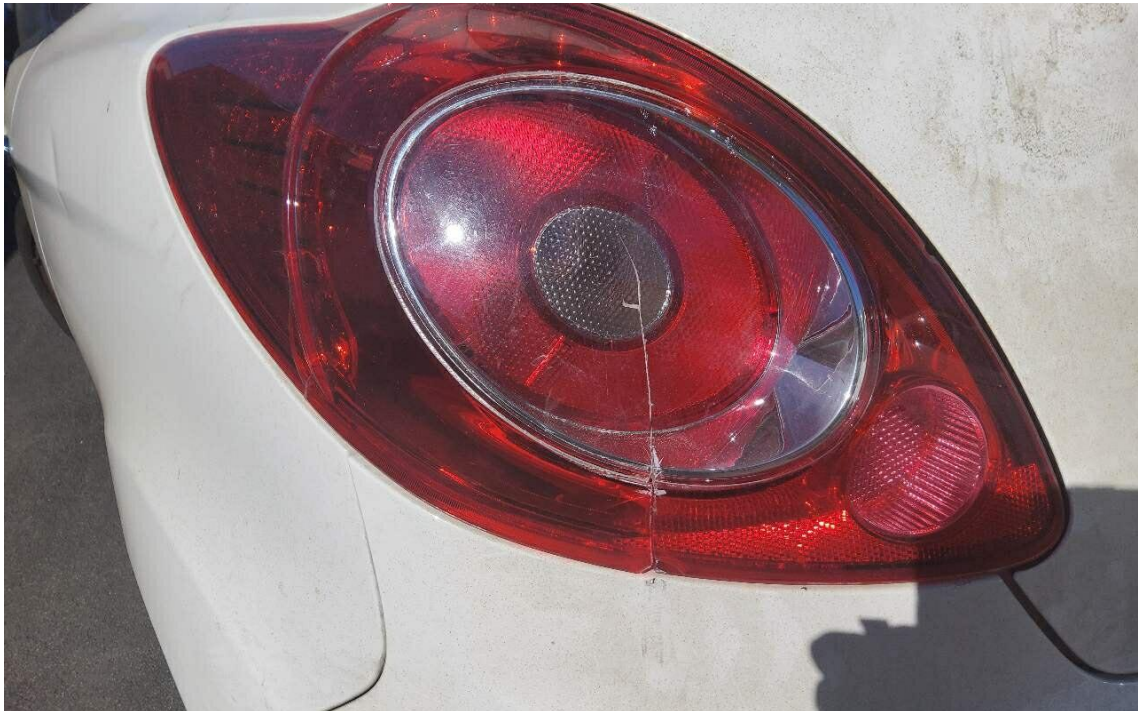
Bild 21 : Stoßfänger hinten gerissen und zerkratzt und Rückleuchte links gebrochen
