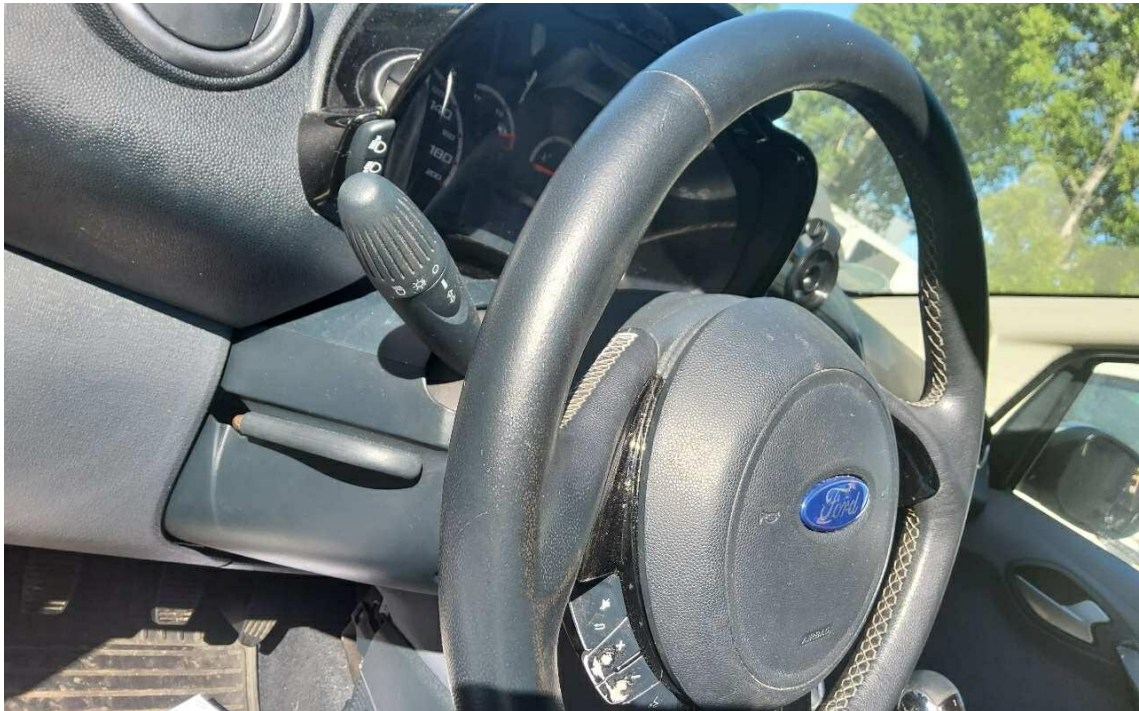
Bild 9 : Lenkrad und Bedienelemente verschlissen
