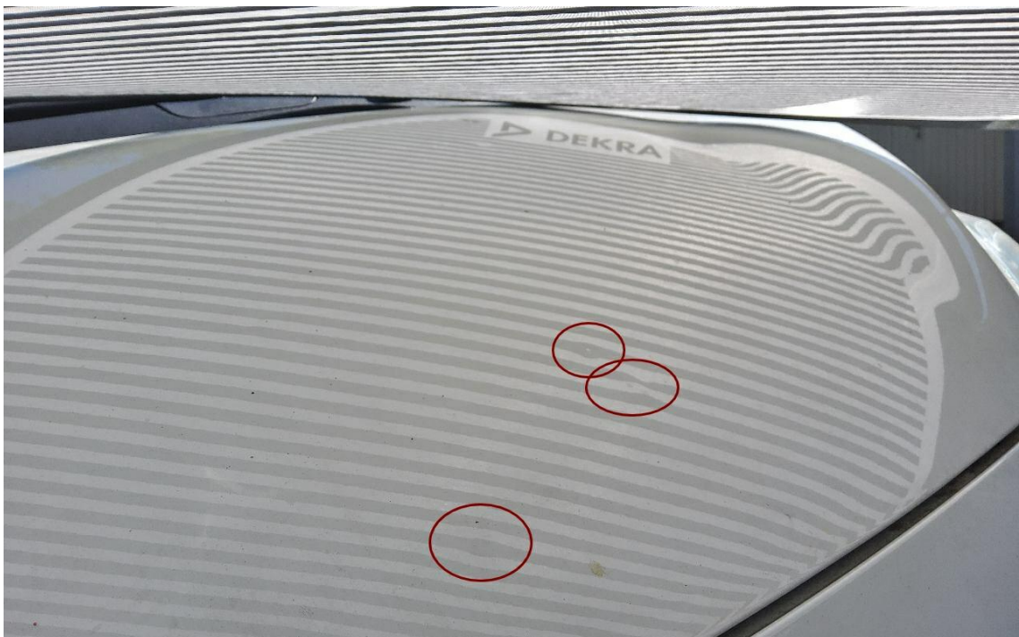
Bild 14 : Motorhaube Dellen, Knick und Lackschaden
