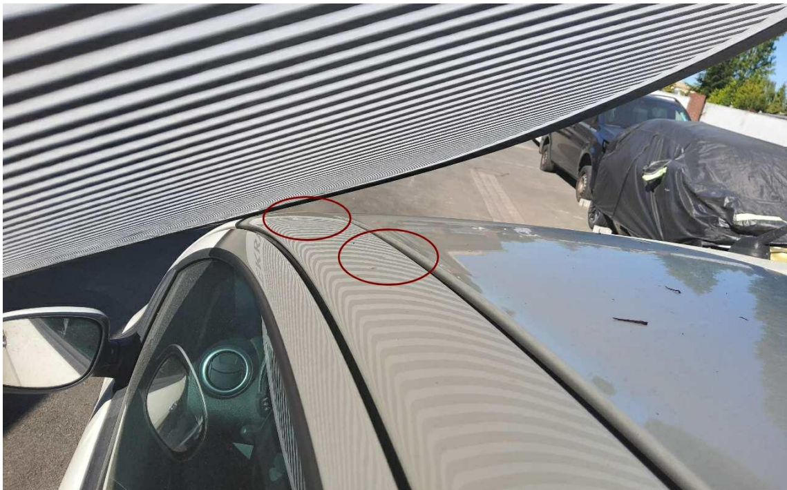
Bild 18 : Dach, Dachrahmen Mehrere Dellen
