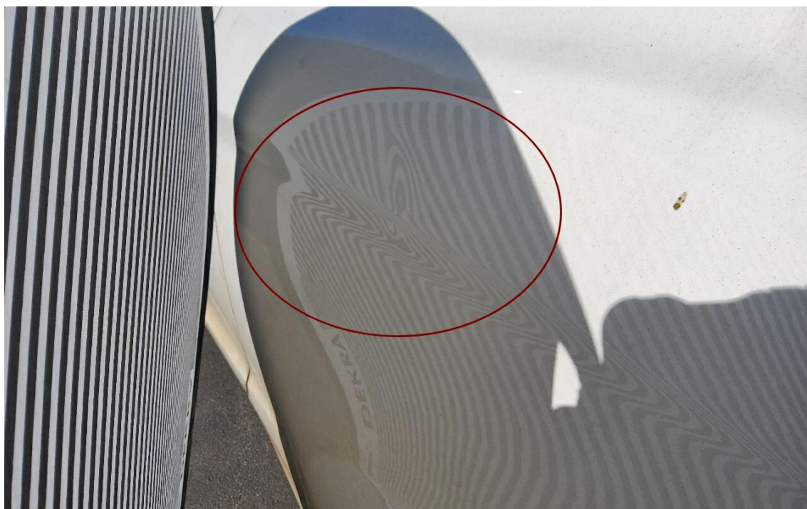
Bild 20 : Seitenteil hinten links deformiert
