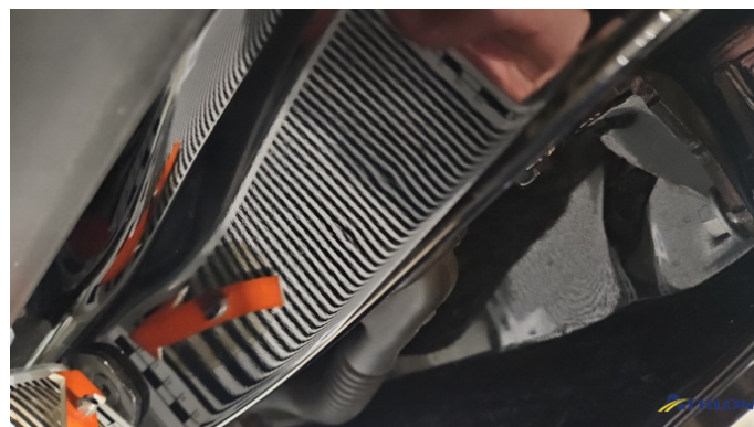
3. Türeinstieg Vorne - Links Verformt (leicht)
