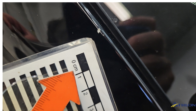
8. A-Säule Vorne - Rechts Steinschlag
