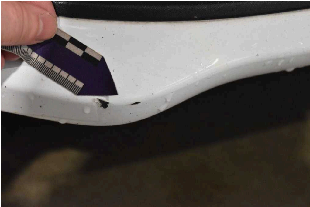
Bild 20 Fahrzeugfront Stoßfänger vorne Kratzer
