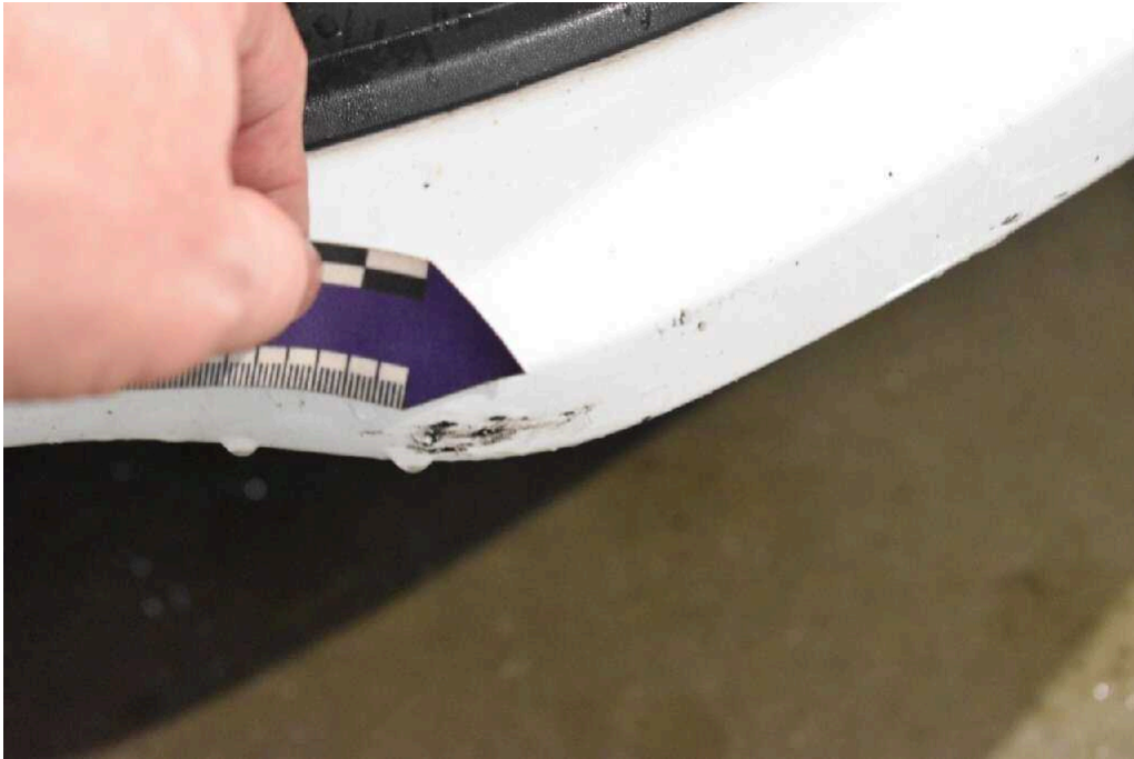
Bild 21 Fahrzeugfront Stoßfänger vorne Kratzer
