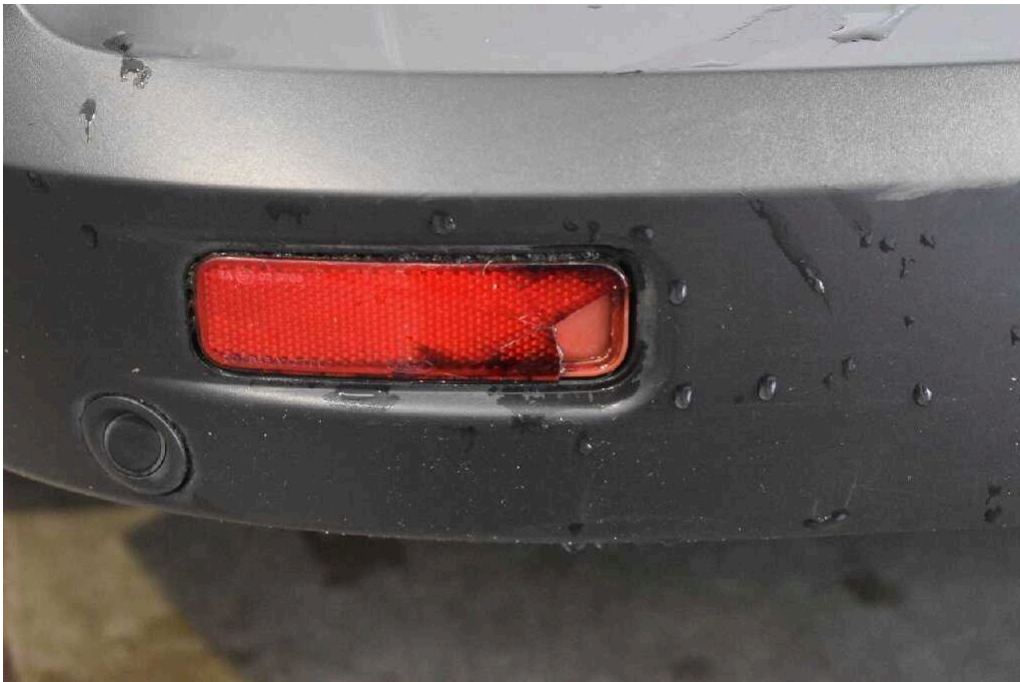
Bild 23 Fahrzeugheck Stoßfänger hinten Rückstahler links gebrochen
