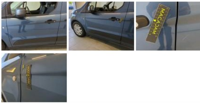
Schuifdeur L, Deuk(en) en kras(sen), Herstellen en spuiten (compleet)
