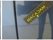
Schuifdeur L, Deuk(en) en kras(sen), Herstellen en spuiten (compleet)
