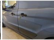
Schuifdeur L, Deuk(en) en kras(sen), Herstellen en spuiten (compleet)
