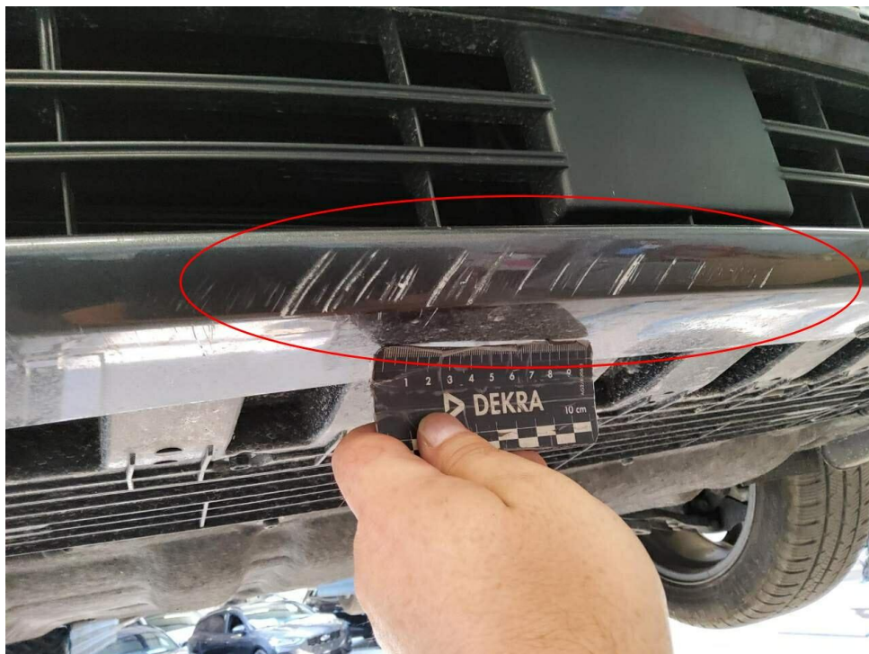
Bild 10 : Frontspoiler Lackierung, verschrammt, smart repair
