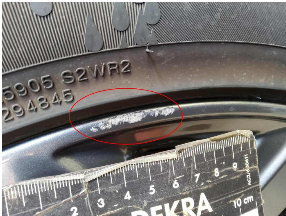
Bild 8 : Felge vorne rechts Lackierung, verschrammt, smart repair
