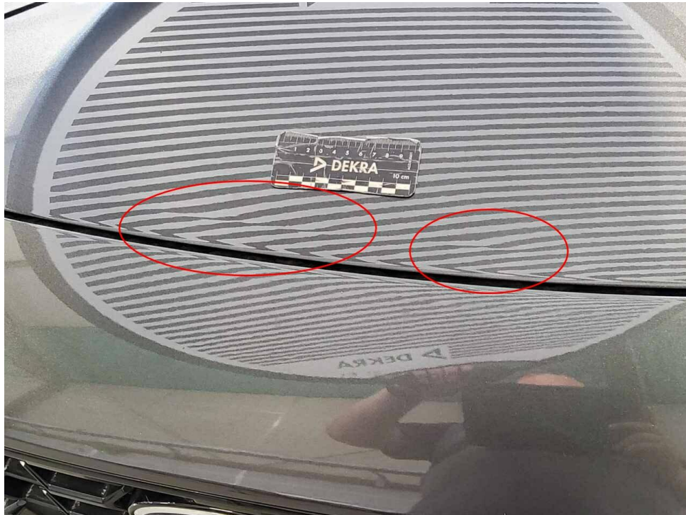
Bild 9 : Motorhaube, mehrfach eingedellt, instandsetzen und lackieren mit Lackaufbau
