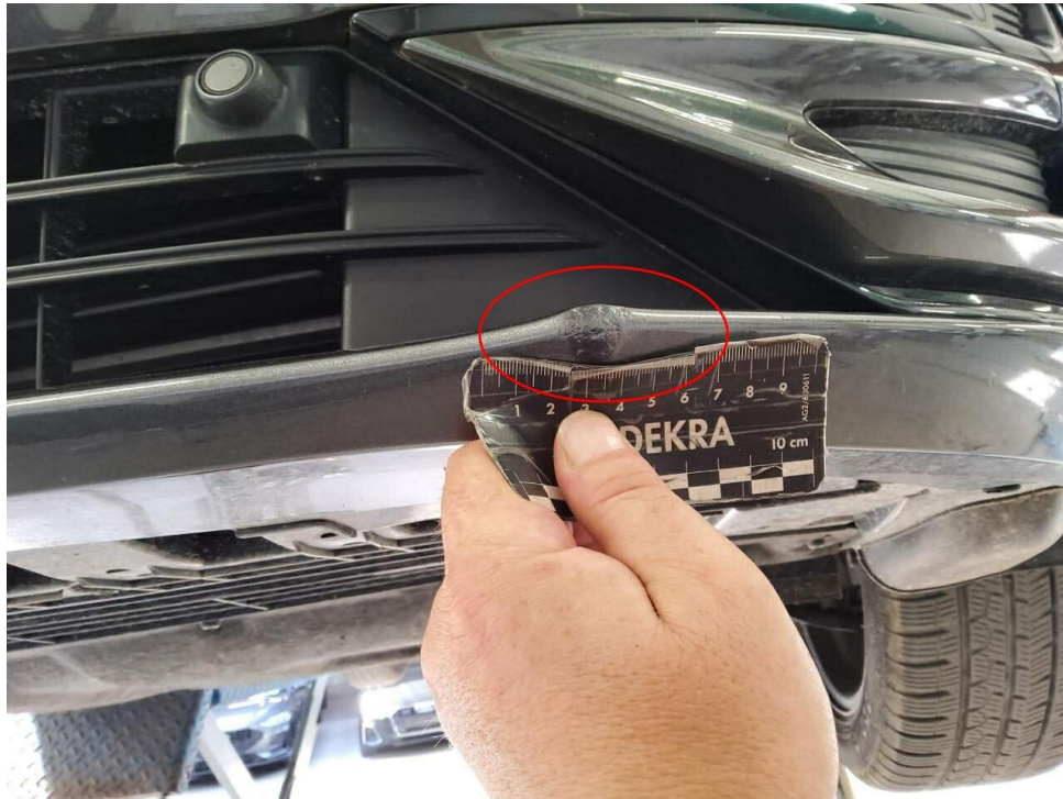
Bild 11 : Frontspoiler Lackierung, verschrammt, smart repair
