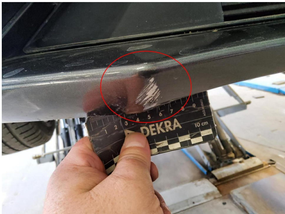
Bild 12 : Frontspoiler Lackierung, verschrammt, smart repair
