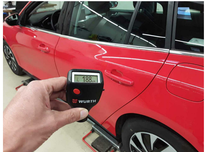
Door - rear left side: 188 µm
