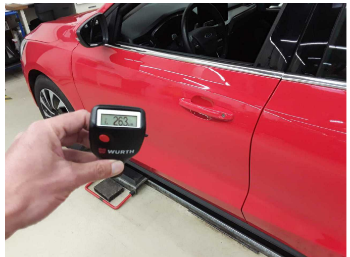
Door - front left side: 263 µm
