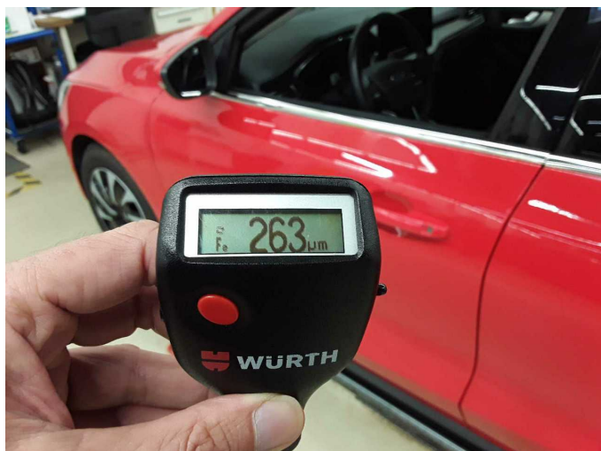
Door - front left side: 263 µm
