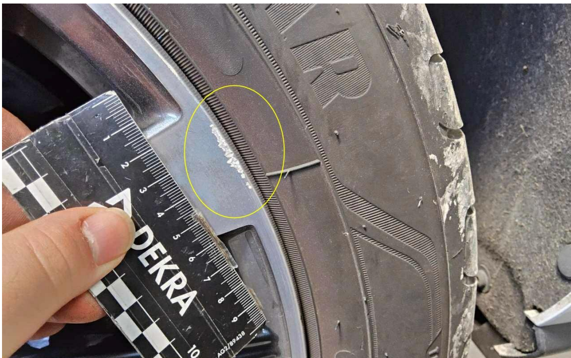
Bild 8 : Felge vorne rechts, verschrammt, smart repair
