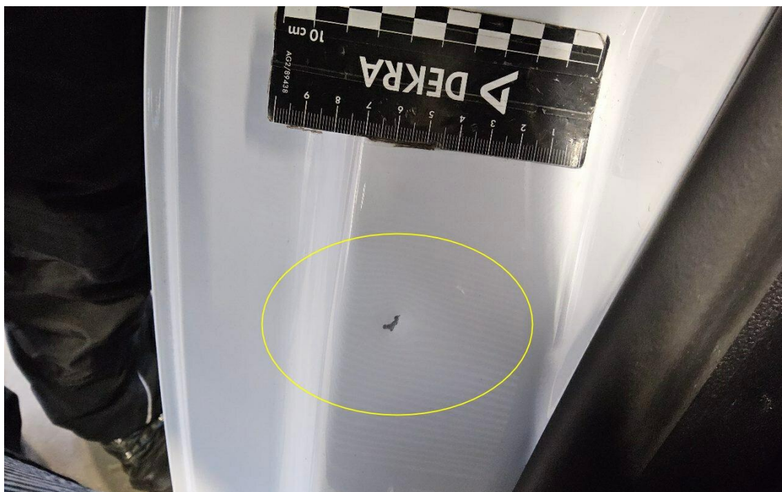
Bild 10 : Einstieg hinten rechts eingedellt
