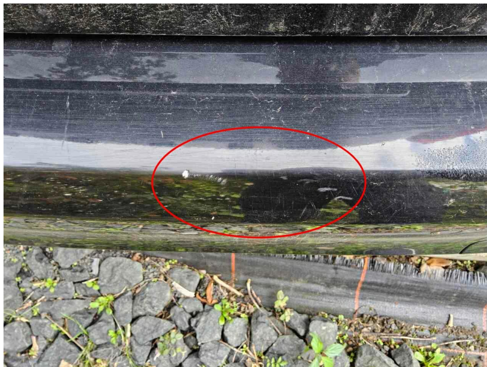
Bild 8 : Stoßfänger hinten Lackierung, verschrammt, lackieren mit Lackaufbau
