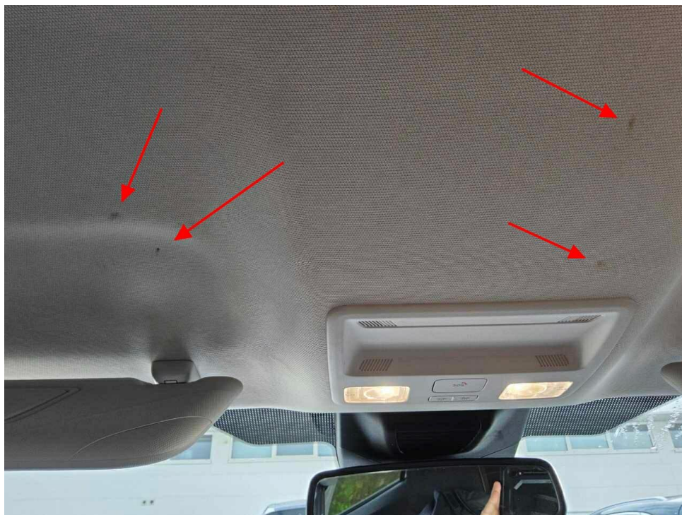
Bild 11 : Dachhimmel, fleckig, reinigen
