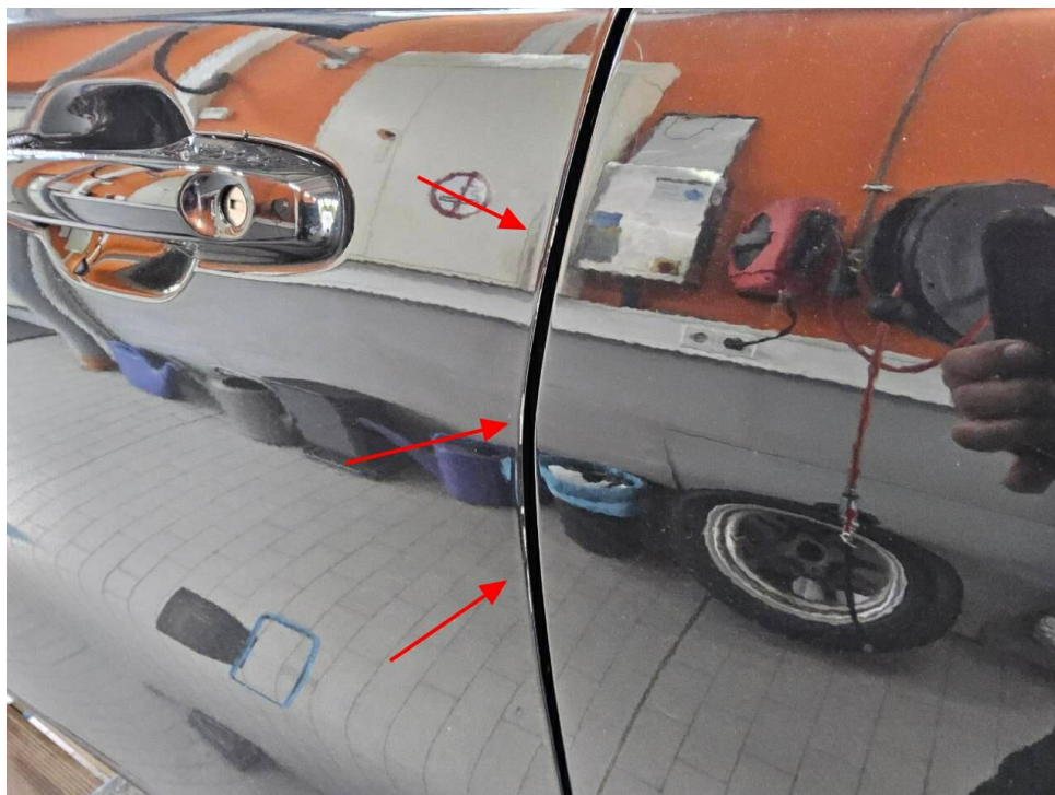
Bild 18 : Tür vorne links Türkante, verschrammt,
