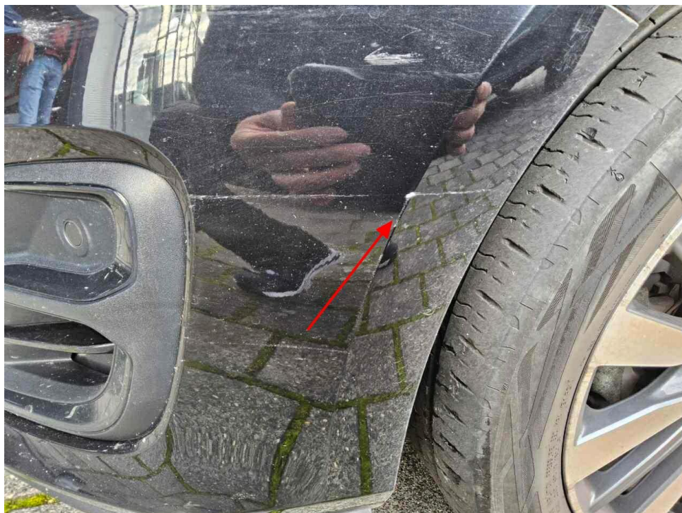
Bild 12 : Stoßfänger vorne Lackierung, verschrammt, lackieren mit Lackaufbau
