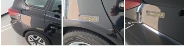
Porte ARD, Griffe(s), LI - Réparer et peindre (complet)
