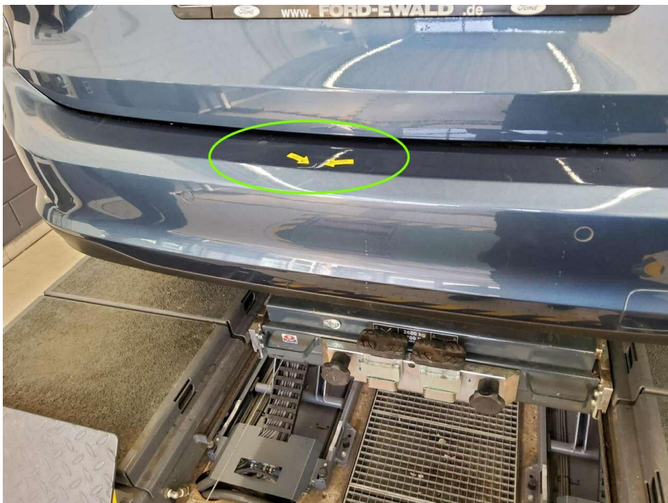
Bild 14 : Stoßfänger hinten Lackierung, zerkratzt, smart repair
