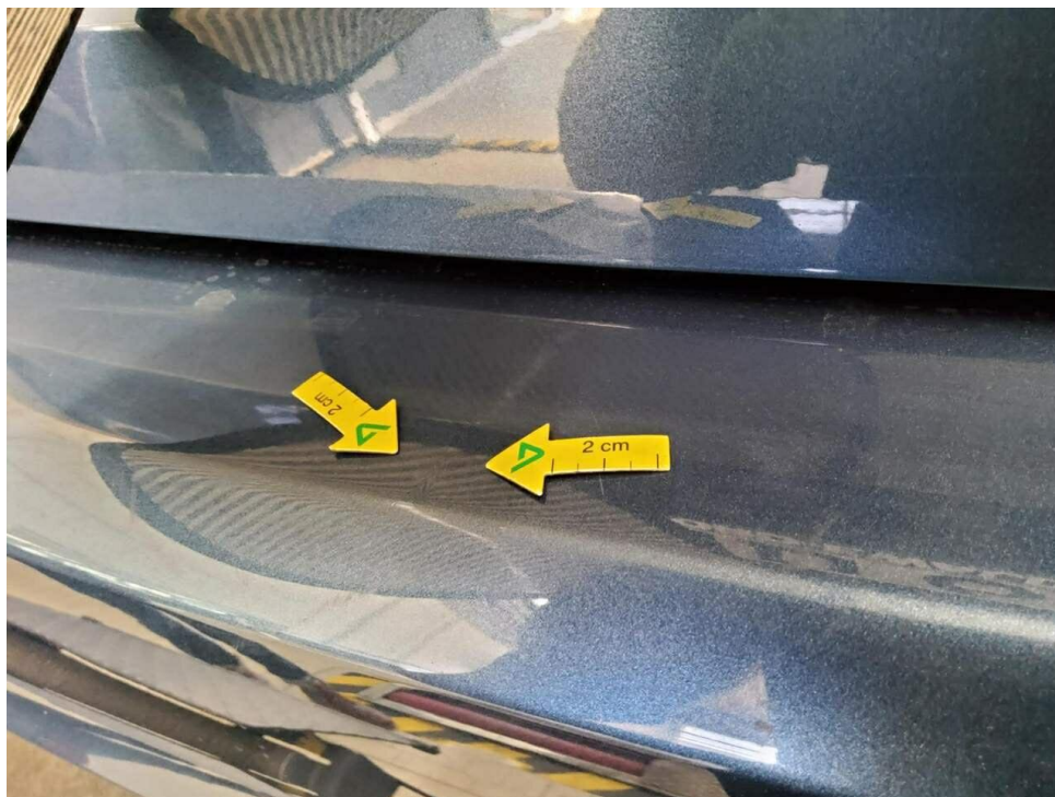
Bild 15 : Stoßfänger hinten Lackierung, zerkratzt, smart repair
