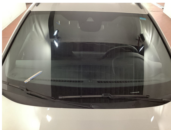
Beschädigung 6: Verglasung: Frontscheibe mit Spurhalteassistent - Steinschlag - erneuern
