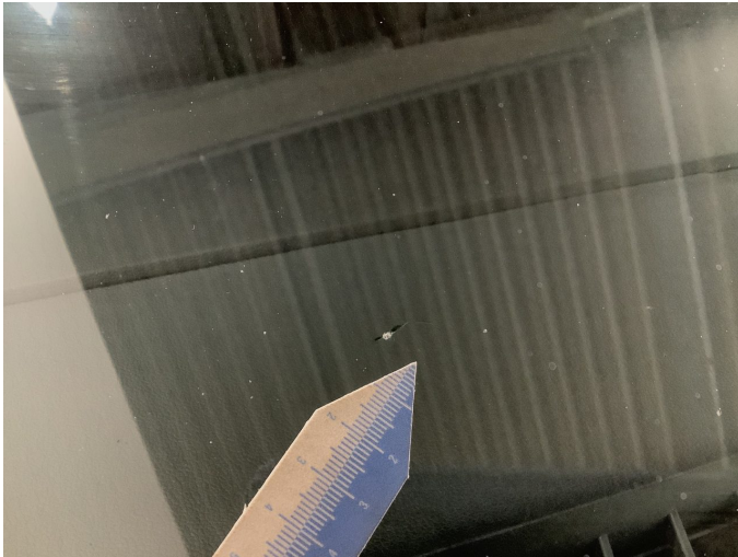
Beschädigung 6: Verglasung: Frontscheibe mit Spurhalteassistent - Steinschlag - erneuern
