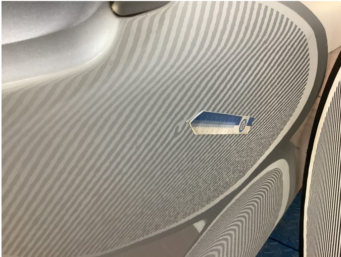
Beschädigung 2: Tür vorn rechts: Tür - Delle(n) - Smart Repair
