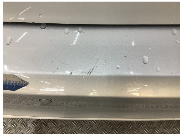
Beschädigung 4: Stossfänger hinten: Stossfänger hinten - Kratzer - lackieren
