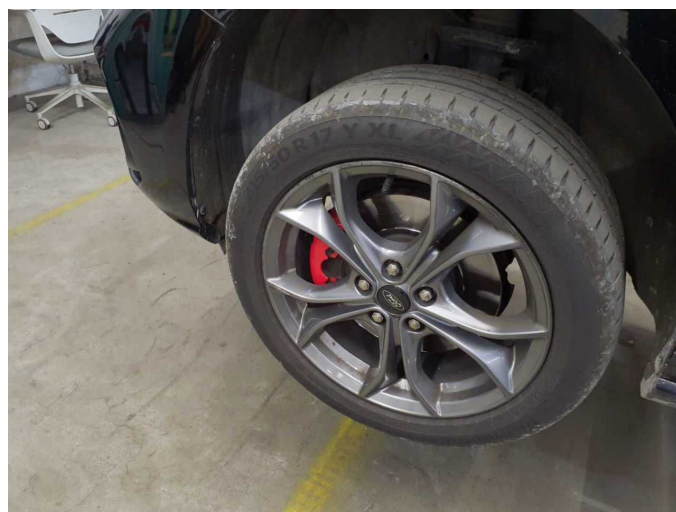
Beschädigung 4: Rad/Reifen: Leichtmetallfelge vorn links - Kratzer - Wertminderung
