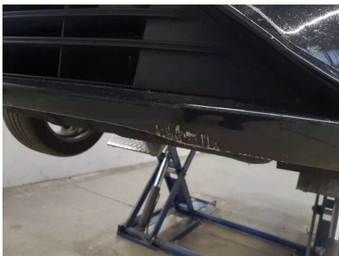
Beschädigung 6: Stossfänger vorn: Stossfänger vorn - beschädigt - instandsetzen und lackieren
