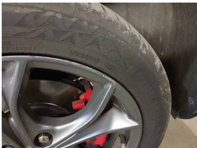
Beschädigung 3: Rad/Reifen: Leichtmetallfelge vorn rechts - Kratzer - Wertminderung
