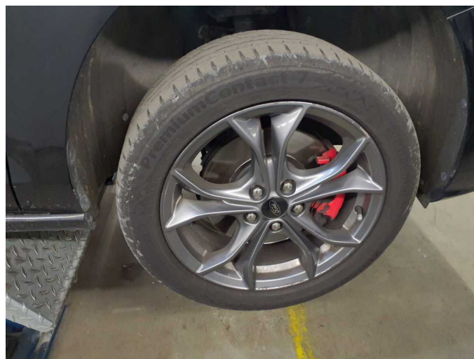
Beschädigung 3: Rad/Reifen: Leichtmetallfelge vorn rechts - Kratzer - Wertminderung
