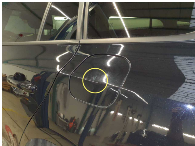
Beschädigung 5: Kraftstoffanlage: Tankdeckel - Kratzer - lackieren
