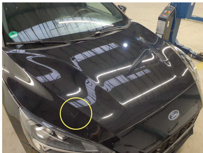
Beschädigung 8: Motorhaube: Motorhaube - Kratzer - lackieren
