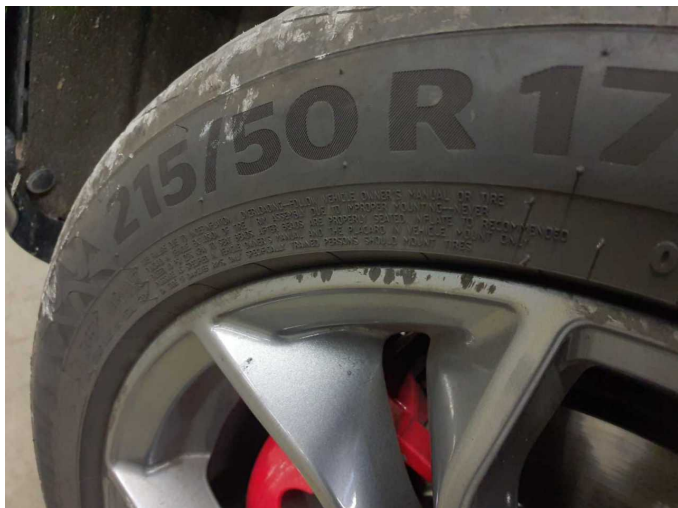
Beschädigung 4: Rad/Reifen: Leichtmetallfelge vorn links - Kratzer - Wertminderung
