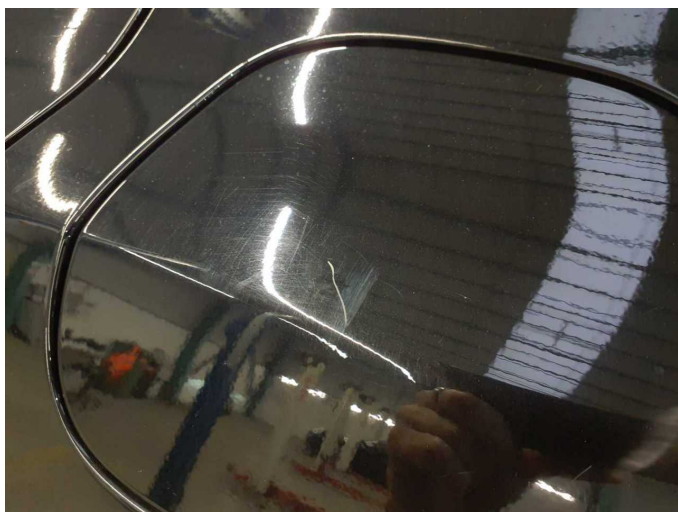
Beschädigung 5: Kraftstoffanlage: Tankdeckel - Kratzer - lackieren
