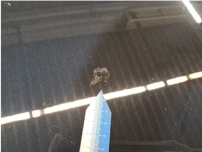
Damage 12: Bonnet: Bonnet (Vogelkotverätzung + Kratzer) - Paint defect - Paint
