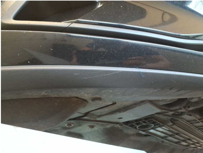
Damage 5: Front bumper: Spoiler (Links und Rechts) - Scratch(es) - Replace
