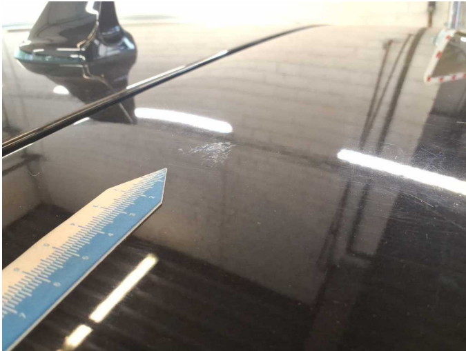
Damage 9: Boot lid / rear door: Rear spoiler (Anätzung) - Paint defect - Paint
