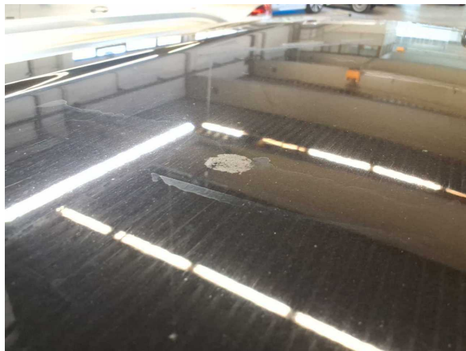
Damage 13: Roof: Roof (Vogelkotverätzung) - Paint defect - Paint
