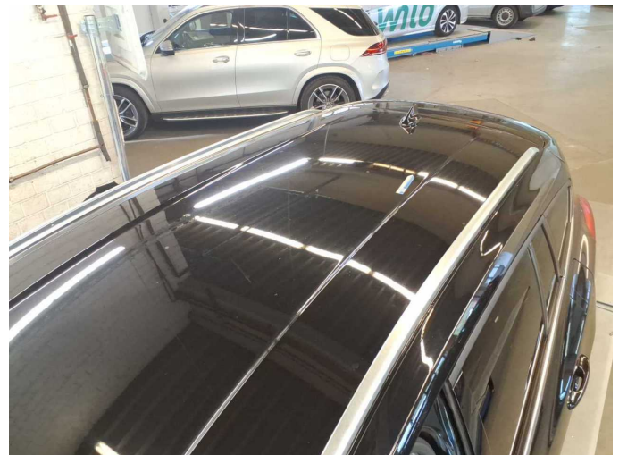
Damage 13: Roof: Roof (Vogelkotverätzung) - Paint defect - Paint
