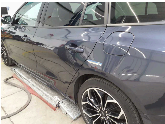
Beschädigung 3: Seitenwand links: Seitenwand - Delle / Lackschaden - instandsetzen und lackieren
