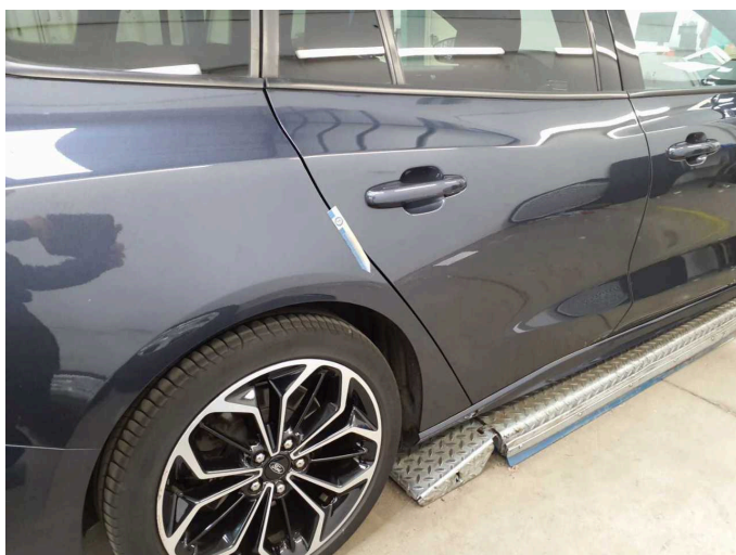
Beschädigung 1: Seitenwand rechts: Seitenwand - Kratzer - Smart Repair
