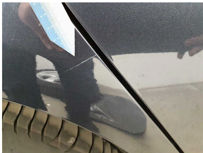
Beschädigung 1: Seitenwand rechts: Seitenwand - Kratzer - Smart Repair
