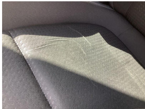
Bild 34: Innenraum / Innenraum Fahrersitz Sitzbezug verschlissen
