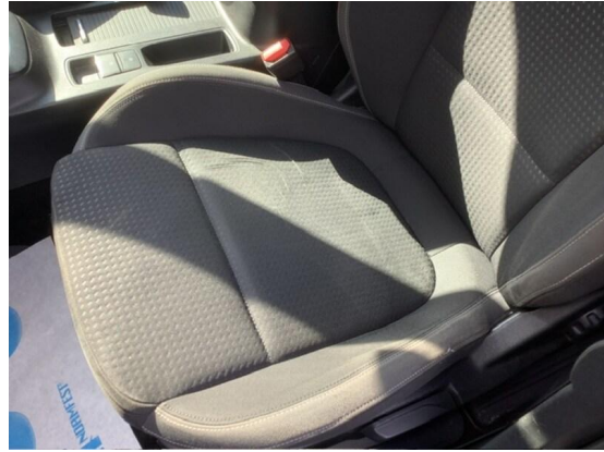
Bild 32: Innenraum / Innenraum Fahrersitz Sitzbezug verschlissen
