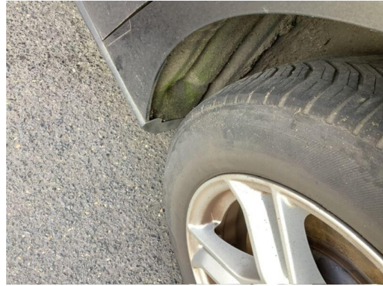
Bild 44: Reifen HL abgefahren
