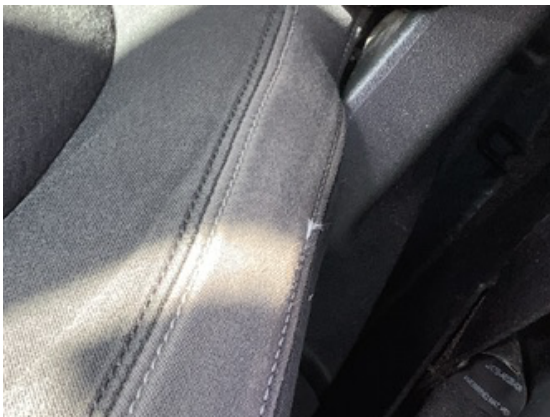
Bild 33: Innenraum / Innenraum Fahrersitz Sitzbezug verschlissen
