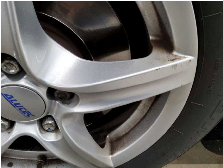
Bild 21 Vorderachse Felge vorne links verschürft
