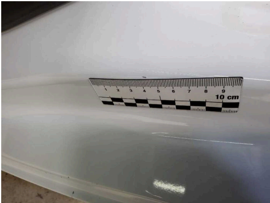
Bild 27 Innenraum Einstieg hinten links Kratzer
