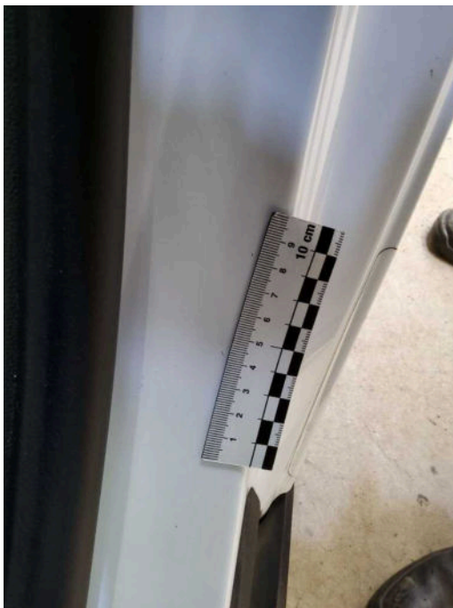
Bild 28 Innenraum Einstieg hinten links Kratzer
