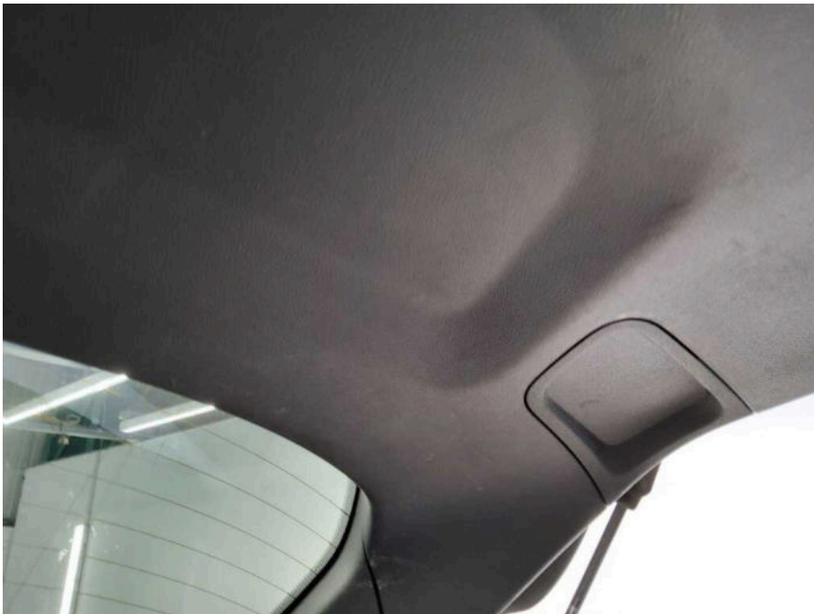
Bild 34 Innenraum Heckklappenverkleidung innen verschürft
