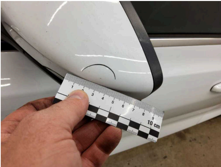
Bild 77 linke Seite Außenspiegelgehäuse links Kratzer
