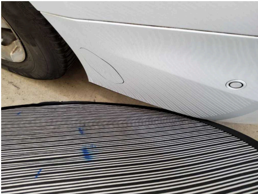
Bild 69 Fahrzeugheck Stoßfänger hinten Delle und Kratzer
