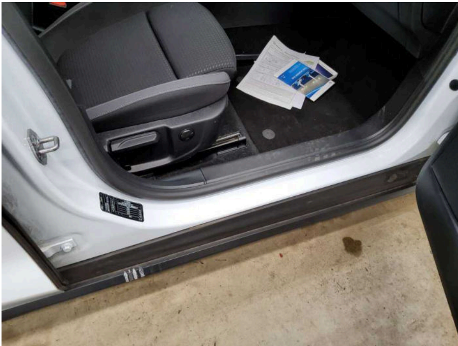
Bild 41 Innenraum Einstieg vorne rechts Delle und Kratzer
