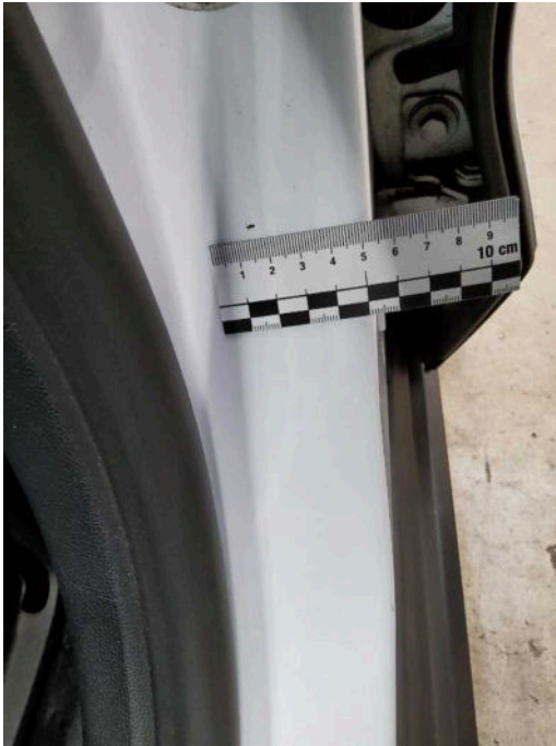
Bild 25 Innenraum Einstieg vorne links Kratzer
