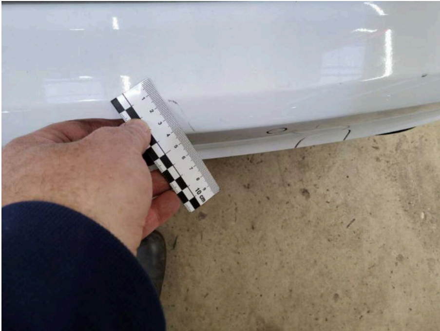
Bild 67 Fahrzeugheck Stoßfänger hinten Delle und Kratzer
