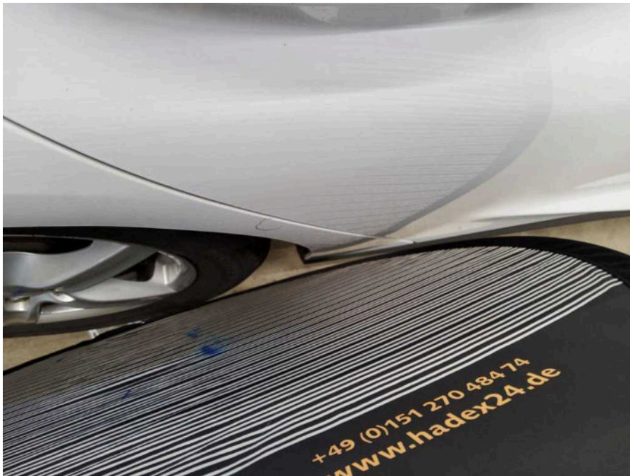
Bild 63 rechte Seite Seitenwand hinten rechts Delle
