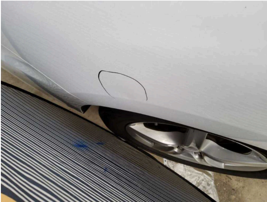
Bild 65 rechte Seite Seitenwand hinten rechts Delle
