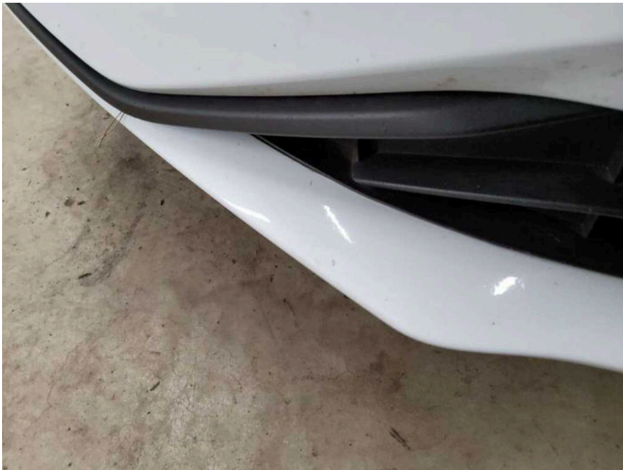
Bild 53 Fahrzeugfront Stoßfänger vorne Delle und verkratzt
