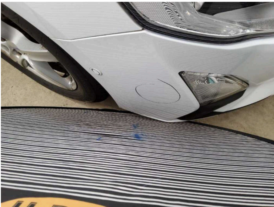
Bild 54 Fahrzeugfront Stoßfänger vorne Delle und verkratzt
