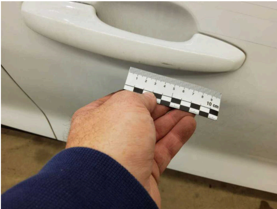
Bild 58 rechte Seite Beifahrertürgriff Kratzer
