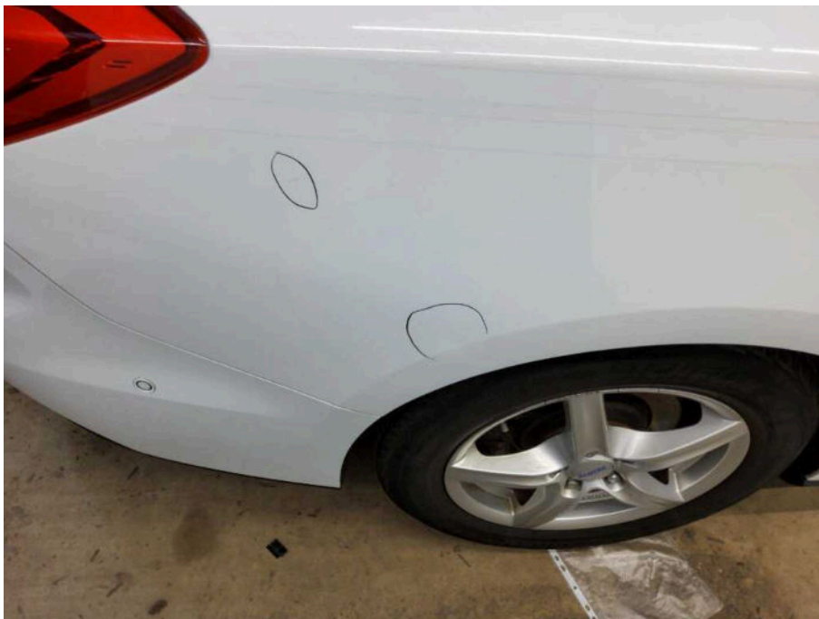
Bild 64 rechte Seite Seitenwand hinten rechts Delle
