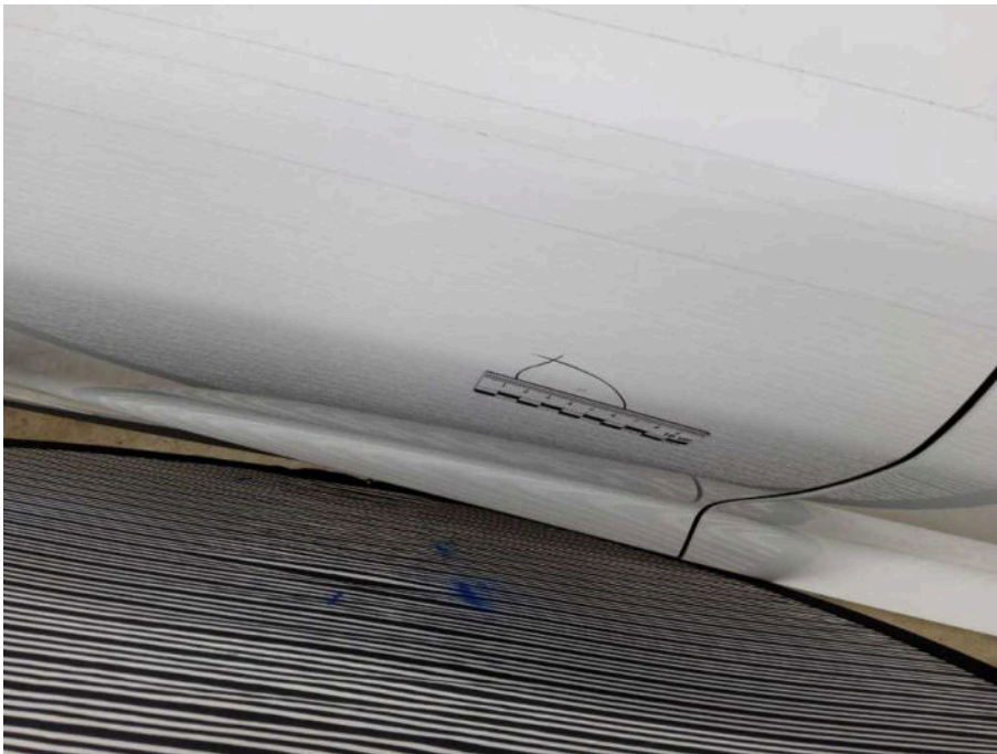
Bild 60 rechte Seite Tür hinten rechts Kratzer
