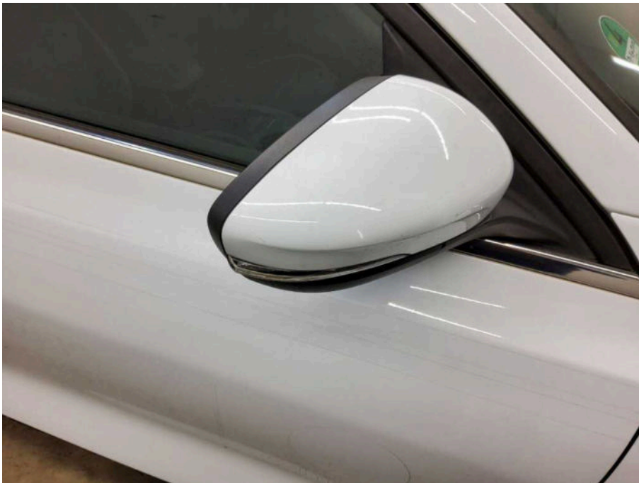
Bild 55 rechte Seite Außenspiegelgehäuse rechts Kratzer
