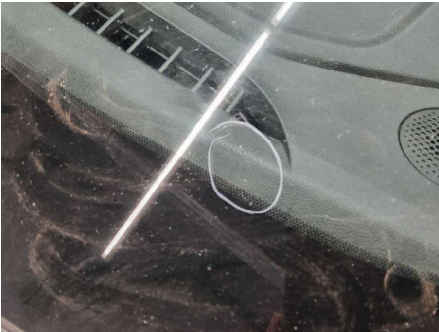
Bild 46 Fahrzeugfront Frontscheibe Steinschlag / -schläge
