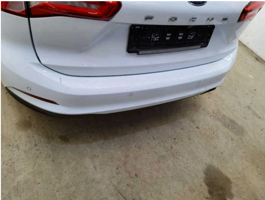
Bild 66 Fahrzeugheck Stoßfänger hinten Delle und Kratzer
