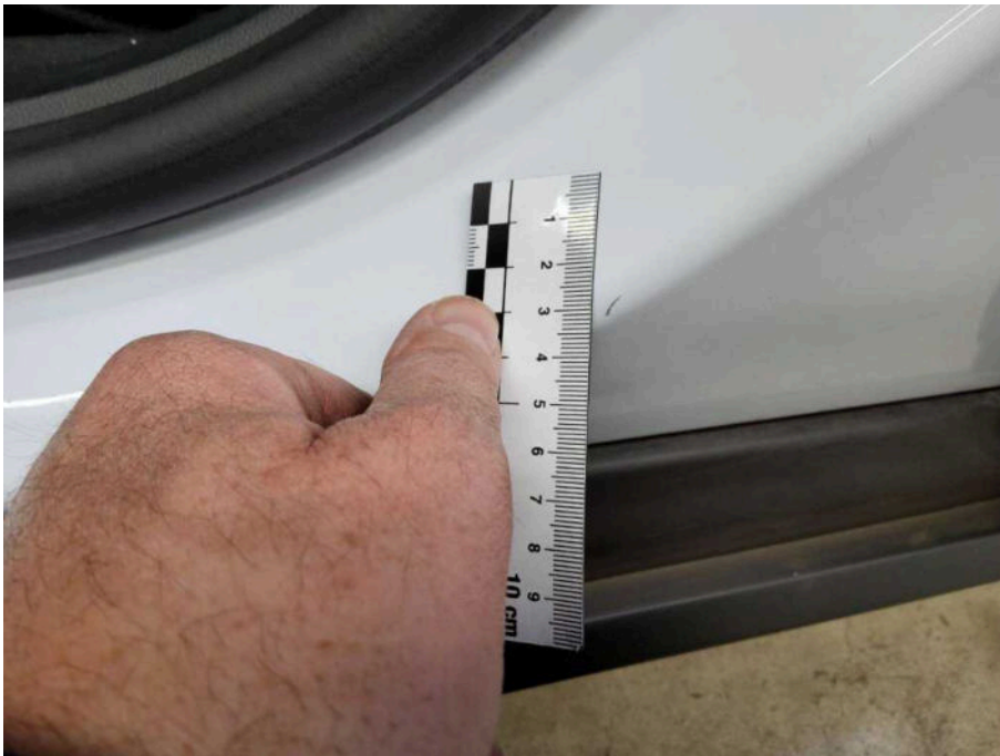
Bild 24 Innenraum Einstieg vorne links Kratzer
