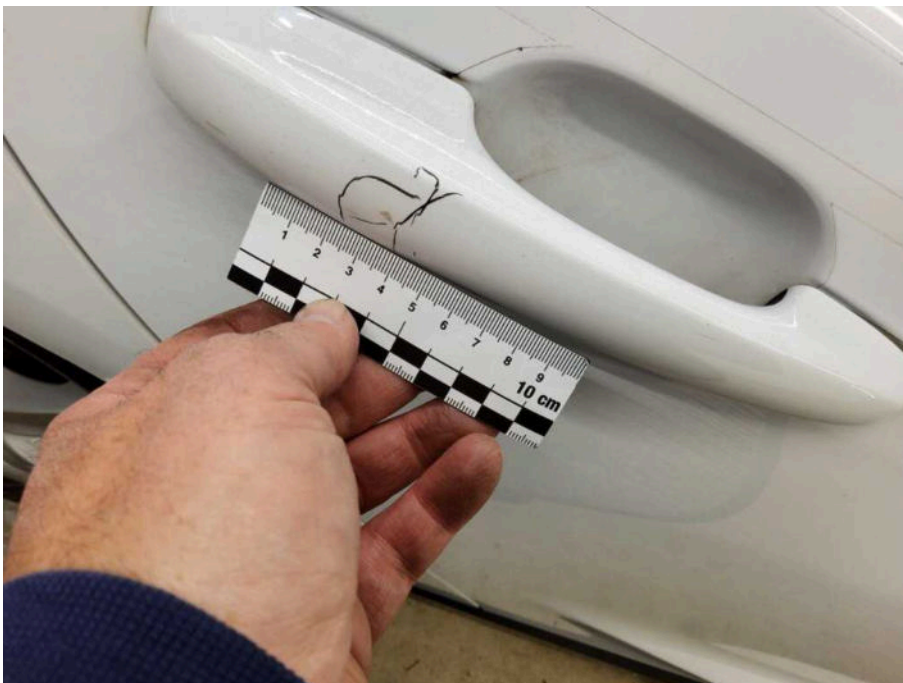
Bild 62 rechte Seite Türgriff hinten rechts außen Kratzer
