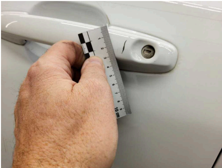
Bild 75 linke Seite Fahrertürgriff Kratzer
