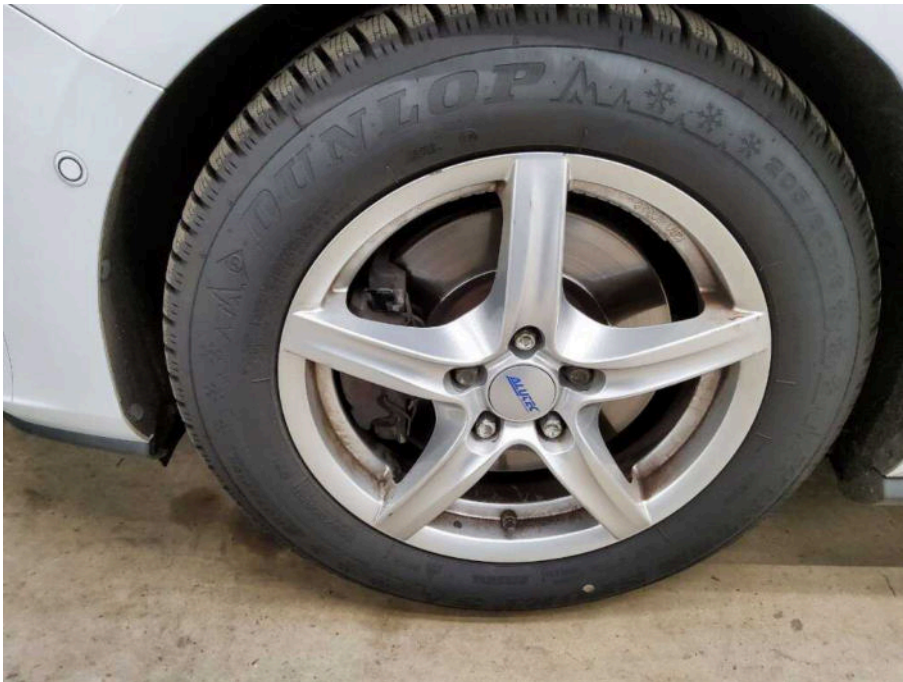
Bild 19 Vorderachse Felge vorne links verschürft
