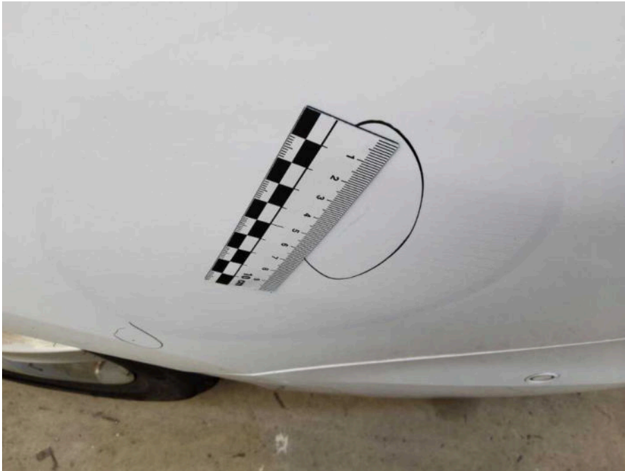
Bild 71 linke Seite Seitenteil hinten links Kratzer
