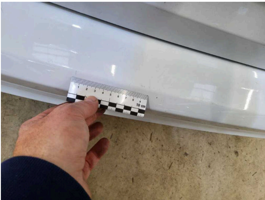
Bild 68 Fahrzeugheck Stoßfänger hinten Delle und Kratzer
