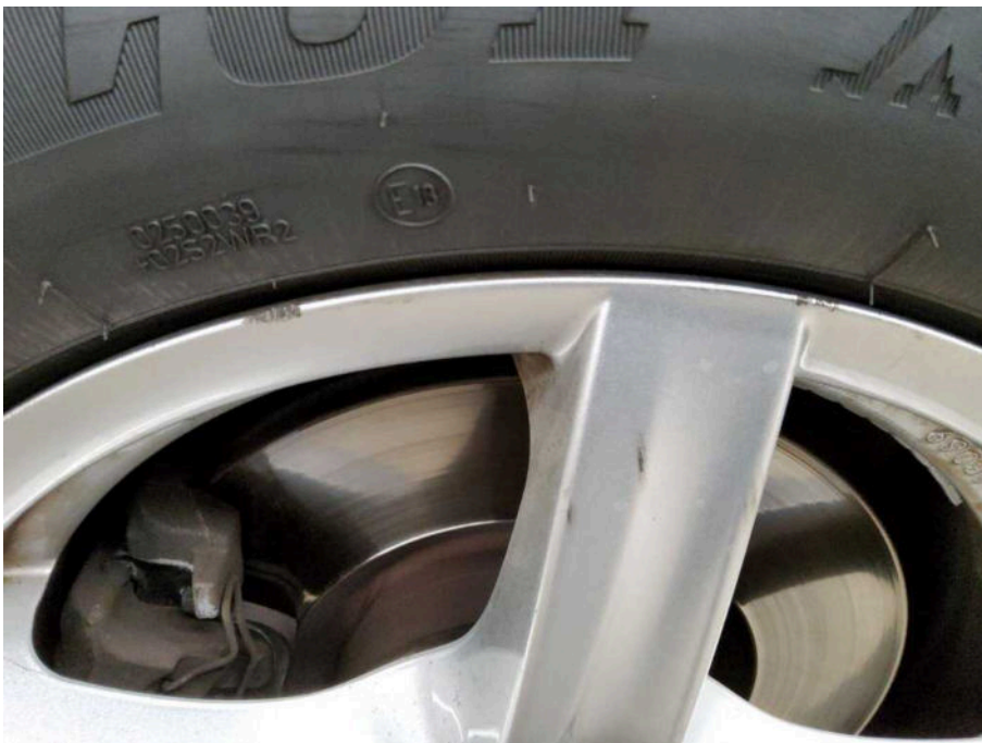
Bild 20 Vorderachse Felge vorne links verschürft
