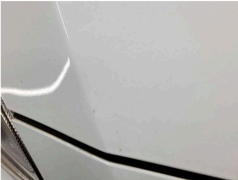
Bild 50 Fahrzeugfront Motorhaube Steinschlag / -schläge
