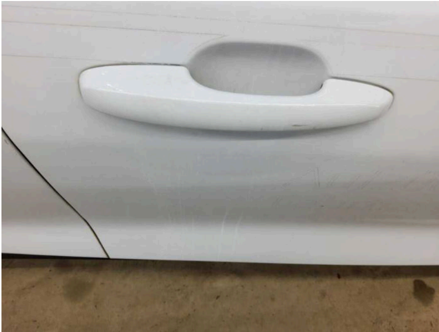
Bild 57 rechte Seite Beifahrertürgriff Kratzer
