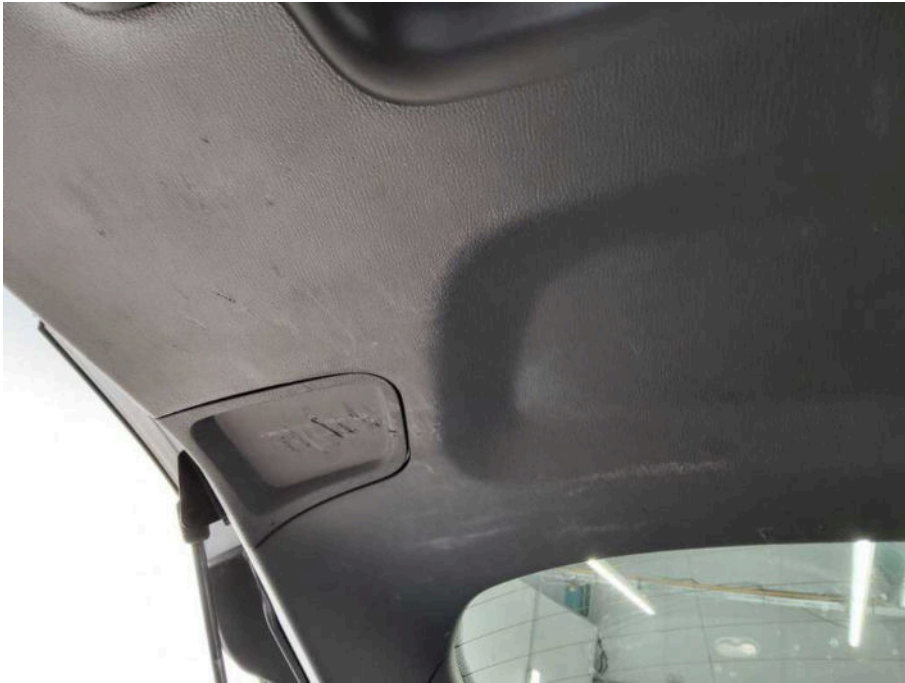
Bild 33 Innenraum Heckklappenverkleidung innen verschürft
