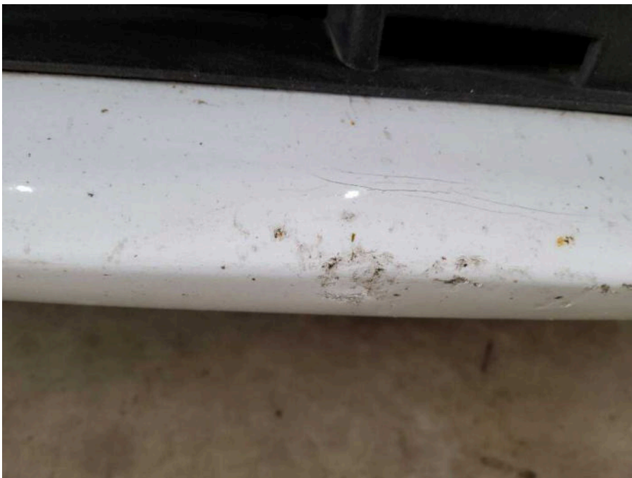
Bild 52 Fahrzeugfront Stoßfänger vorne Delle und verkratzt
