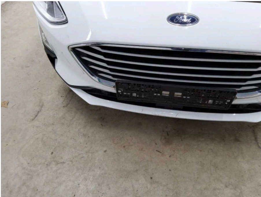
Bild 51 Fahrzeugfront Stoßfänger vorne Delle und verkratzt
