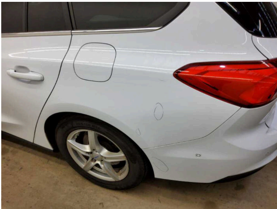
Bild 70 linke Seite Seitenteil hinten links Kratzer
