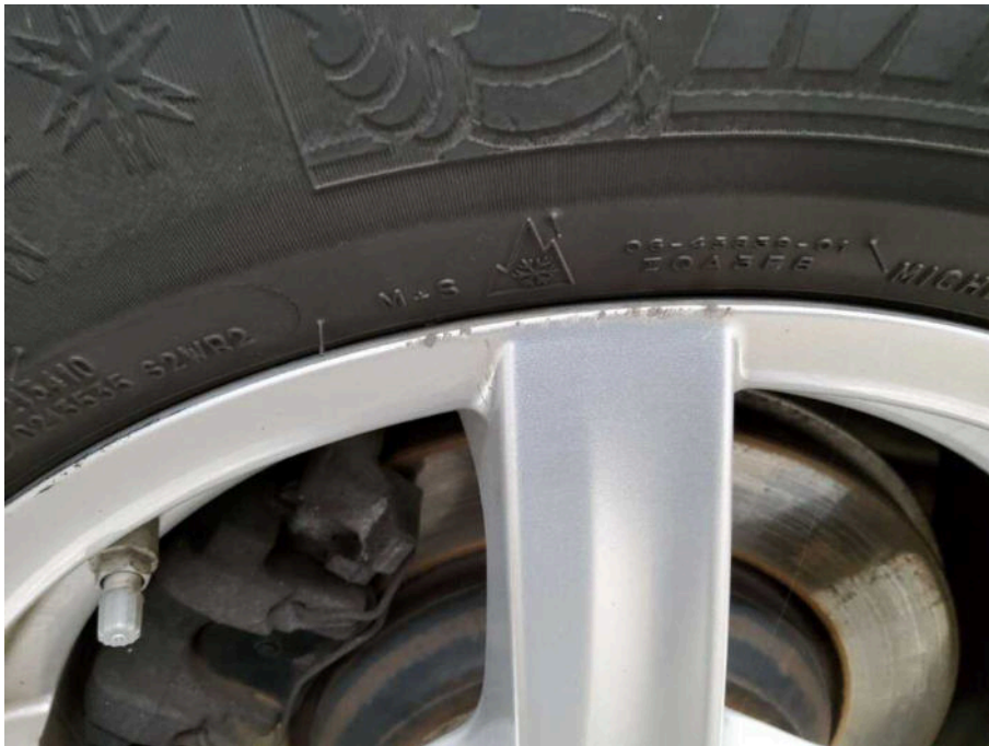
Bild 35 Hinterachse Felge hinten rechts verschürft
