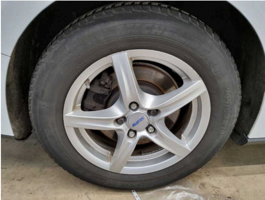
Bild 29 Hinterachse Felge hinten rechts verschürft
