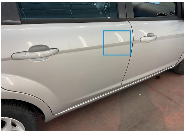
19. Door / Back Right Bodywork / Dent -
