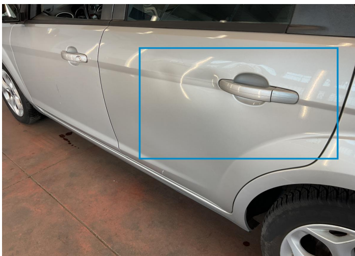
11. Door / Back Left Bodywork / Dent -
