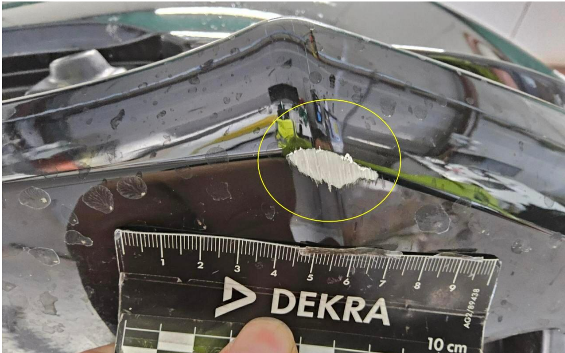
Bild 9 : Stoßfänger vorne Lackierung, verschrammt, smart repair
