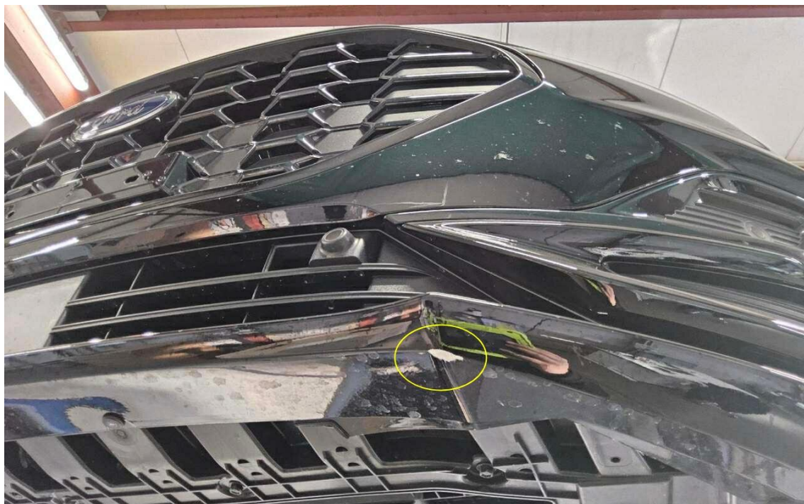
Bild 8 : Stoßfänger vorne Lackierung, verschrammt, smart repair
