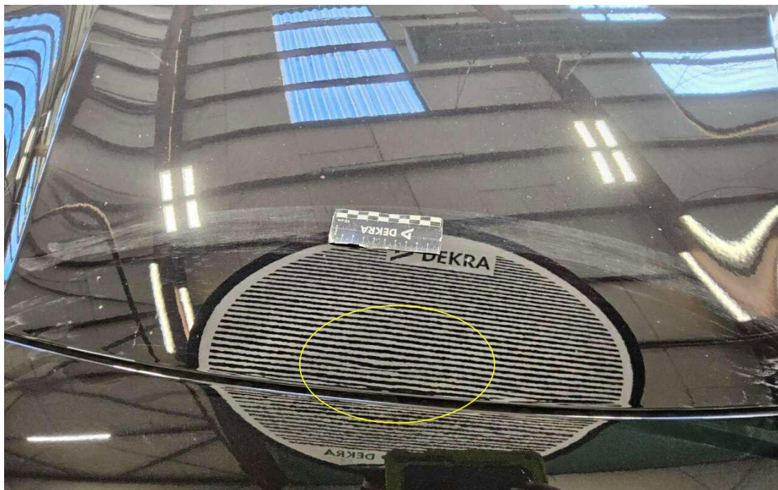
Bild 11 : Motorhaube, eingedellt, smart repair
