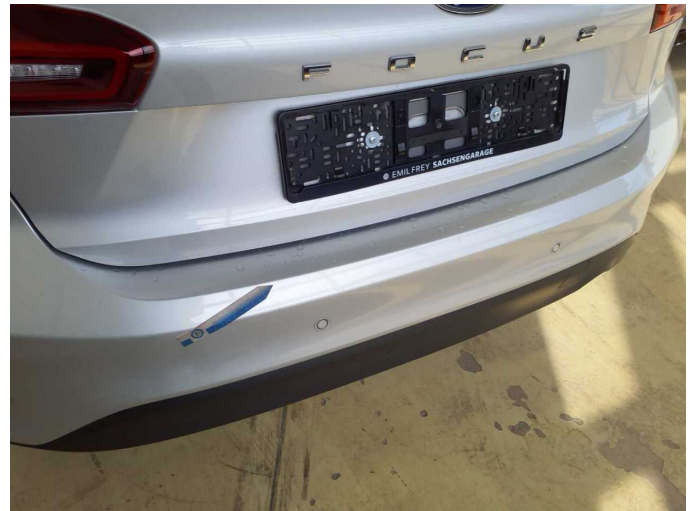
Damage 3: Rear bumper: Rear bumper (Druckstelle geht über die Kante) - dent(s) - Repair and paint
