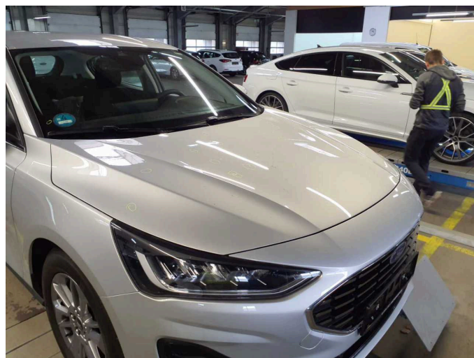
Beschädigung 3: Karosserie: Karosserie - Hagelschaden - sanft instandsetzen
