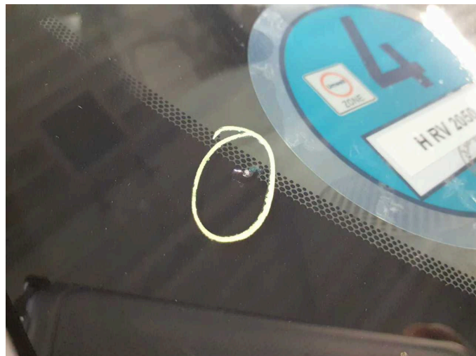
Beschädigung 2: Verglasung: Frontscheibe mit Spurhalteassistent - Steinschlag - erneuern
