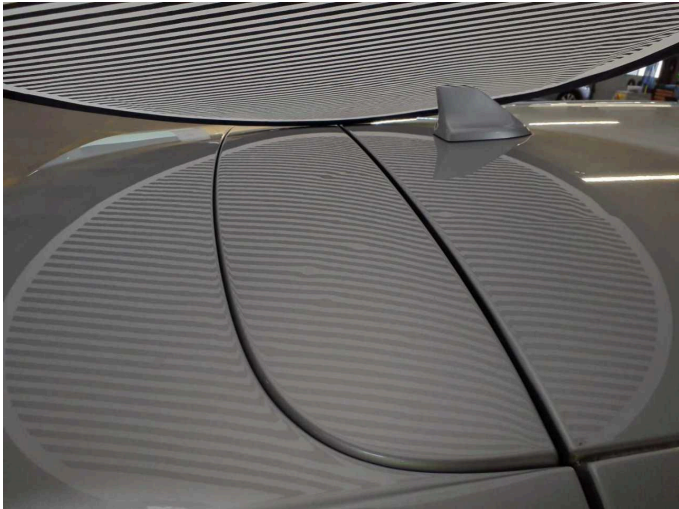
Beschädigung 3: Karosserie: Karosserie - Hagelschaden - sanft instandsetzen
