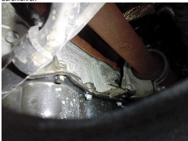
Beschädigung #4: Motor: Motorölwanne - undicht - Diagnose durchführen
