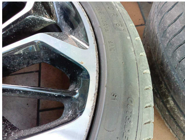
Beschädigung #8: 2.Radsatz: 1 Leichtmetallfelge (Materialabrieb) - verkratzt / verschürft - erneuern
