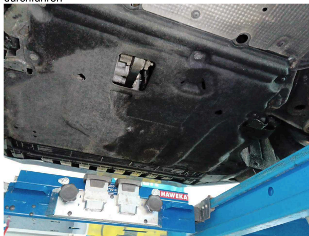
Beschädigung #4: Motor: Motorölwanne - undicht - Diagnose durchführen
