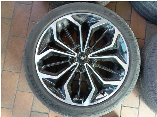
Beschädigung #8: 2.Radsatz: 1 Leichtmetallfelge (Materialabrieb) - verkratzt / verschürft - erneuern
