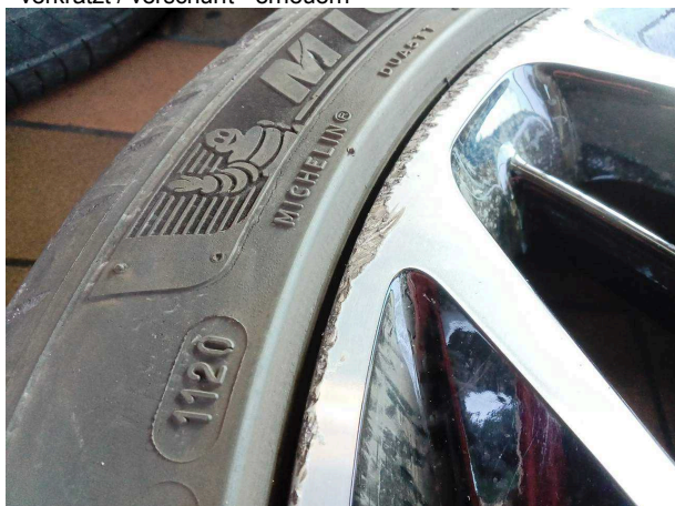
Beschädigung #8: 2.Radsatz: 1 Leichtmetallfelge (Materialabrieb) - verkratzt / verschürft - erneuern
