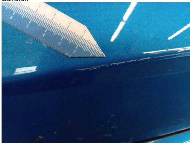
Beschädigung #10: Tür vorn links: Tür - verkratzt / verschürft - lackieren
