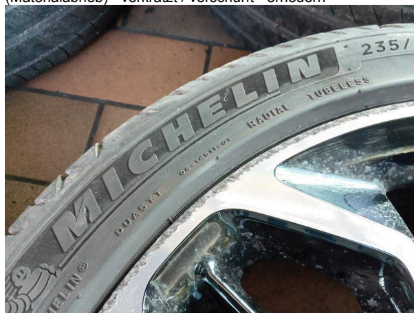
Beschädigung #8: 2.Radsatz: 1 Leichtmetallfelge (Materialabrieb) - verkratzt / verschürft - erneuern
