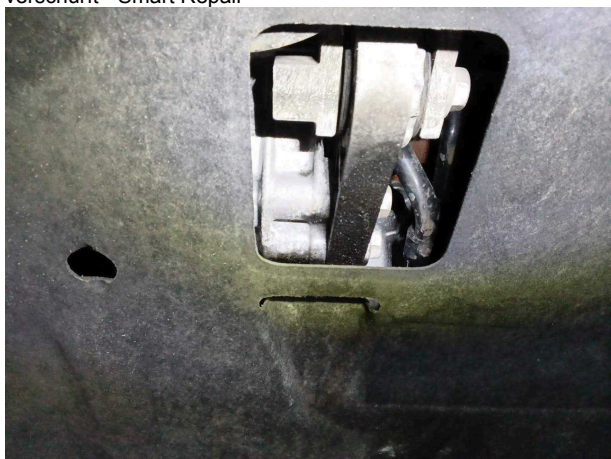
Beschädigung #4: Motor: Motorölwanne - undicht - Diagnose durchführen
