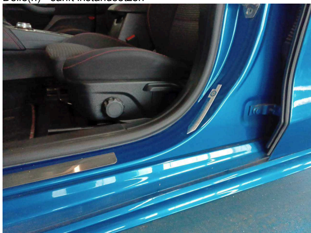
Beschädigung #2: Schweller links: Einstieg - Kratzer - Smart Repair
